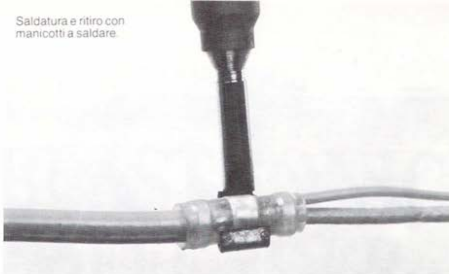
Il generatore d'aria calda AG700 Weller si presenta come un saldatore: dotato di una punta ed una pinzetta può saldare e dissaldare anche componenti SMD o (foto) scaldare il termorestringente.
