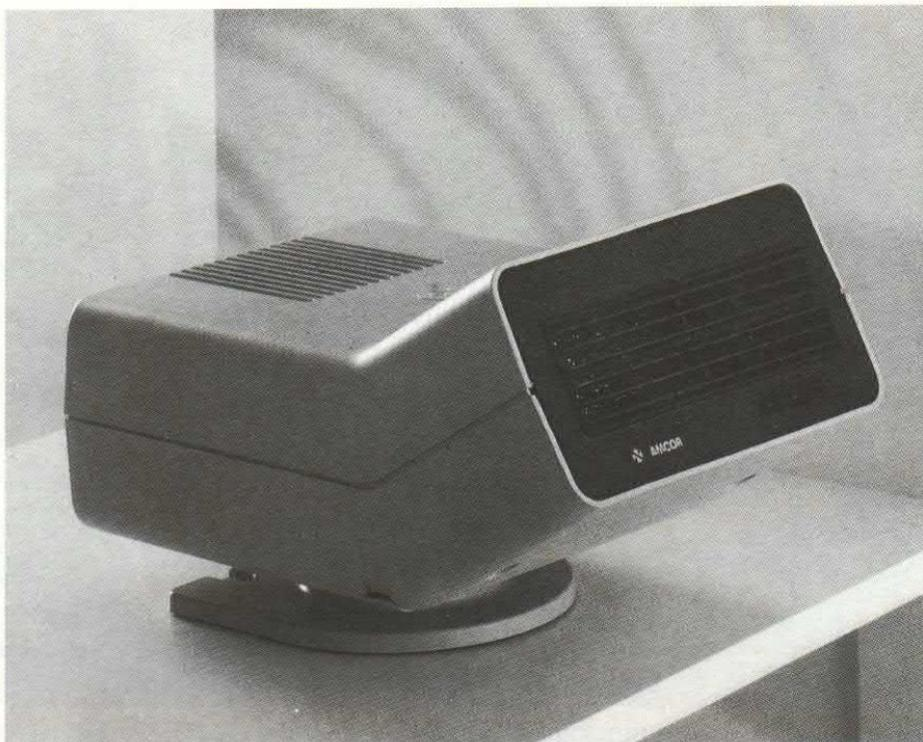
**Un depuratore/ionizzatore d'aria da tavolo (air-processor) prodotto dalla AMCOR; è composto da una ventola ed un filtro elettrostatico per prelevare e filtrare l'aria che viene poi ionizzata negativamente e immessa nell'ambiente.**
