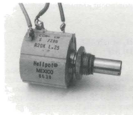
Per poter sintonizzare agevolmente i vari canali è bene utilizzare, per R9, un potenziometro a 10 giri.
