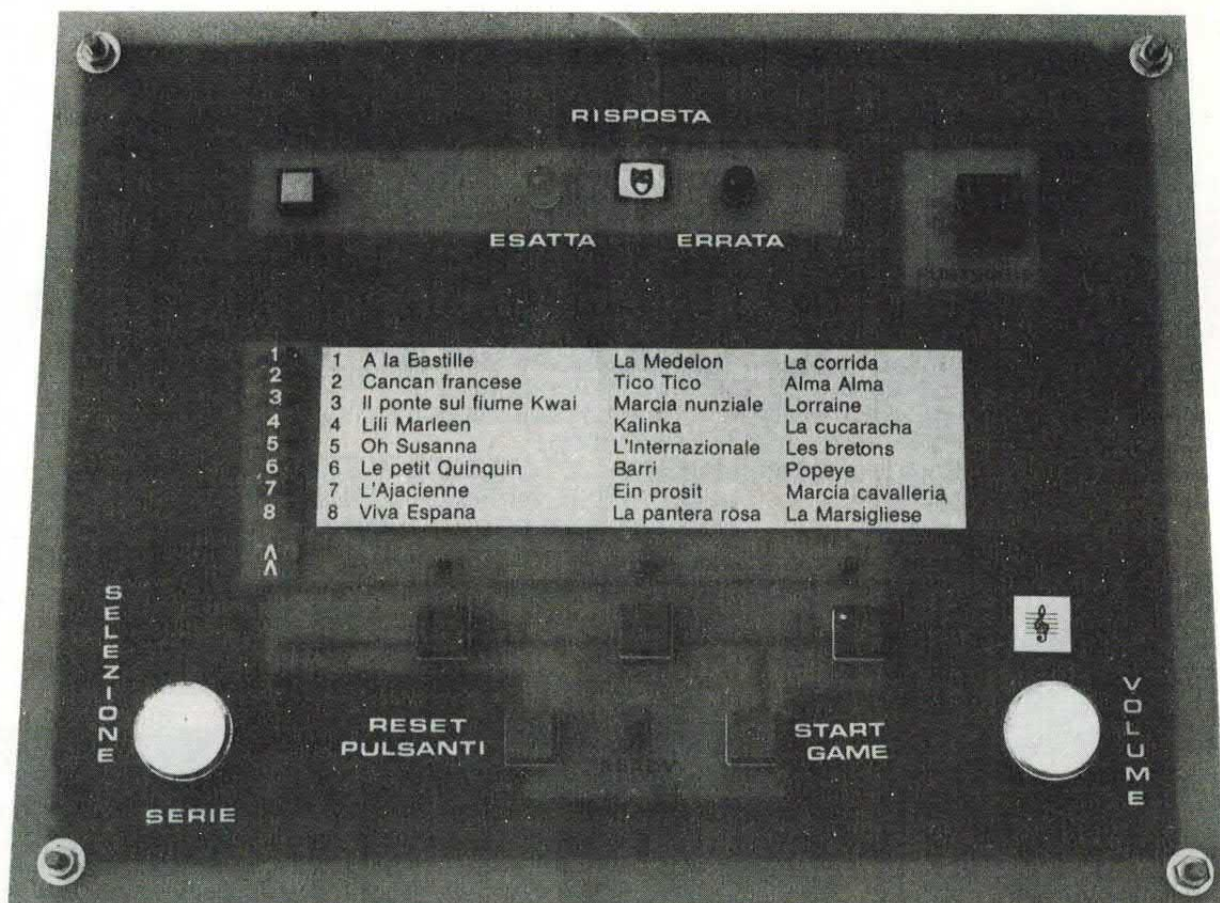
Sulla scheda segnalazioni, che va montata di sopra, sono alloggiati LED, display, pulsanti, commutatore di selezione dei gruppi e potenziometro del volume.
