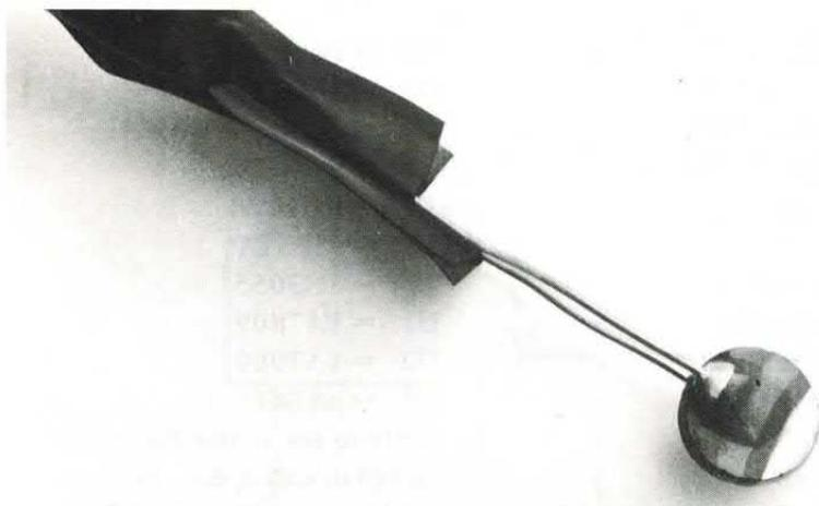
Per mantenere la temperatura, alimentiamo la cella di Peltier mediante un termostato il cui sensore è un termistore NTC.
