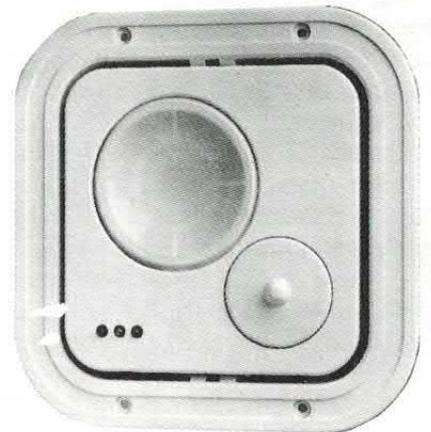
te fuori portata di possibili atti di vandalismo. Il DT 5360 presenta un campo di rivelazione di 360° ed un raggio di rivelazione di 15 metri. L'altezza del montaggio può variare da 2,5 a 5 metri. L'esclusivo sistema di specchi intercambiabili del rivelatore fornisce 72 zone ottiche in quattro strati e garantisce la massima sicurezza di funzionamento.
