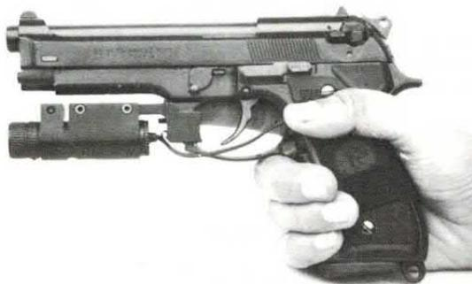
non richiede alcun intervento sulla meccanica della pistola: il sistema di puntamento potrà perciò essere rimosso in qualsiasi momento. Per l'allineamento è invece necessario recarsi al poligono: con una chiavetta a brugola andranno effettuate le opportune regolazioni sui due assi sino ad ottenere la perfetta coincidenza tra la proiezione del laser e il punto d'impatto del proiettile. La portata del laser è più che sufficiente per questo tipo di applicazione.
