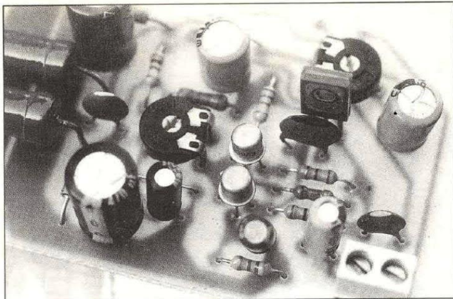
Lo sfasatore è un semplice amplificatore differenziale realizzato con transistor a basso rumore (PNP2N3963) e connesso in modo invertente. Il suo guadagno si regola con un trimmer.
