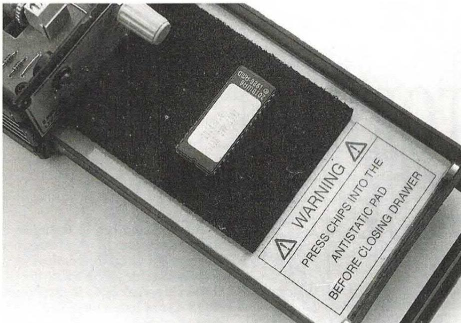
Il cassetto va realizzato in modo da impedire l'uscita della luce UV ad apparecchio in funzione, e tenendo conto che tutto chiuso deve far scattare (chiudere) lo switch di sicurezza. Ricordate che i raggi UVC sono pericolosi per gli occhi, pertanto non accendete i tubi prima di aver chiuso bene il contenitore.
