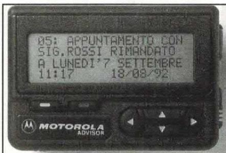
Dotato di un avanzato sistema di memorizzazione che permette di introdurre in 2 diversi archivi, l'uno storico, l'altro personalizzato, fino a 40 messaggi di massimo 80 caratteri ciascuno, "Advisor" è un utilissimo strumento di lavoro e non solo.
