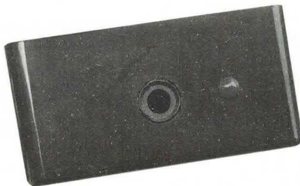
La fotoresistenza va messa in fondo ad un tubo che si affaccia all'esterno da una superficie della scatola.
