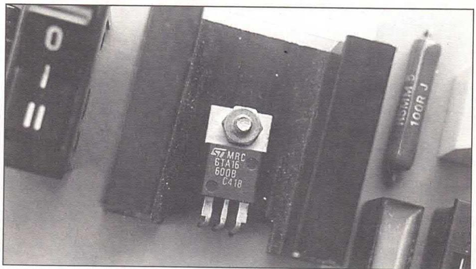
Il triac va montato su un dissipatore avente resistenza termica non maggiore di 10 °C/W, interponendo uno strato di pasta al silicone tra i due, allo scopo di migliorare lo smaltimento del calore.
