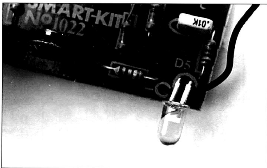
L'accensione di un LED evidenzia la presenza, nel muro o nell'immediato sottosuolo, di un oggetto metallico. Il potenziometro della sensibilità va regolato fino a far illuminare e spegnere tale LED.
