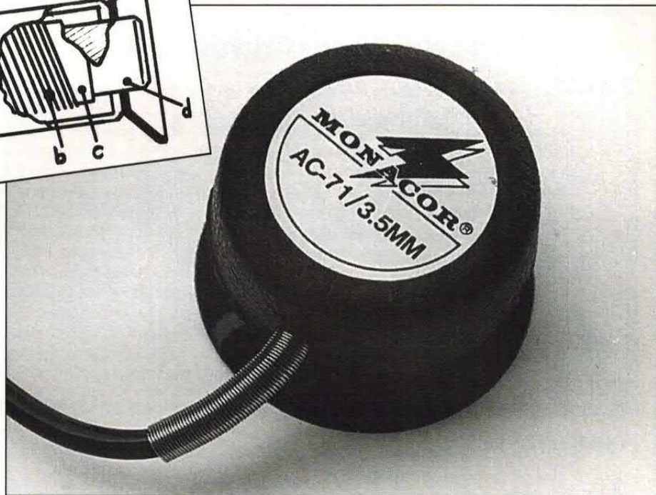
Il captatore telefonico vero e schematizzato: solitamente è composto da un contenitore plastico (a) con ventosa in gomma morbida (e) nel quale si trova un nucleo ferromagnetico (d) su cui è avvolto del filo di rame (b) isolato da un foglio di carta (c) o plastica.
