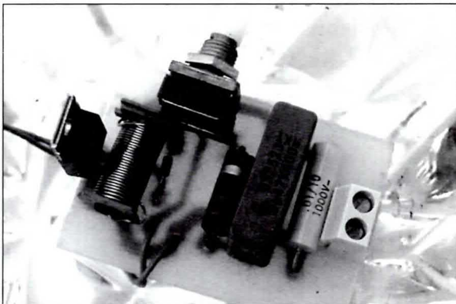
Il circuito è semplicissimo: pochi condensatori e resistenze, un triac e un diac; quanto basta per realizzare un varialuce automatico. Un potenziometro permette di aggiustare la soglia di accensione.
