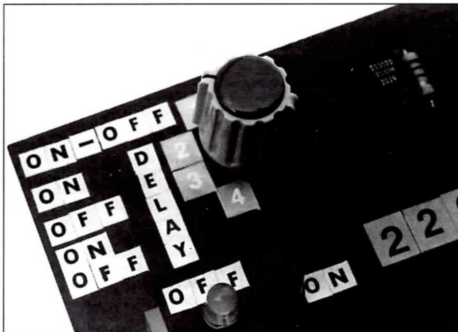
I modi di funzionamento (attivazione e spegnimento, istantanei oppure ritardati) dell'interruttore elettronico si possono selezionare mediante un commutatore rotativo, provvisto di manopola.
