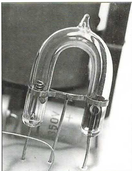
La lampada occorrente è del tipo flash allo xenon (o xeno che dir si voglia) della potenza di almeno 5 watt.
