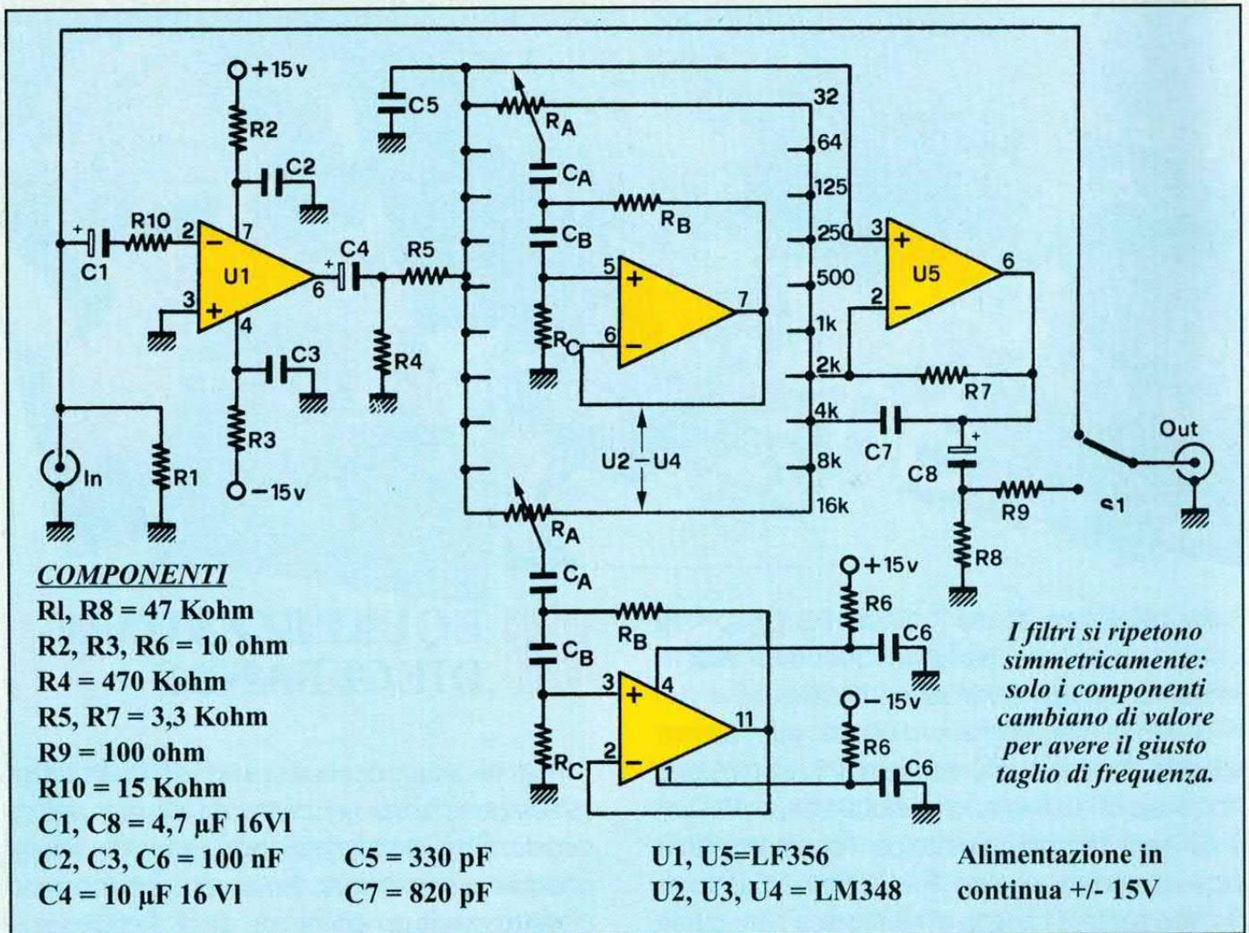
pagina 4. I dieci potenziometri (RA) debbono tutti essere del tipo a variazione lineare; l'impiego di elementi a cursore (sliders) consentirà una migliore e più rapida regolazione del guadagno dei vari filtri. Per alimentare il dispositivo è necessaria una tensione di alimentazione di  $\pm 15$  volt; l'assorbimento è del tutto trascurabile. Mediante il commutatore S1 risulta possibile escludere il
