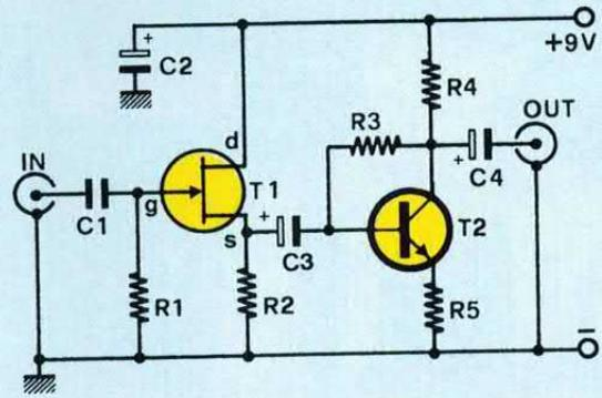
secamente una elevatissima impedenza d'ingresso. Il secondo stadio fa capo al BC 108B montato nella configurazione ad emettitore comune. Il guadagno di tale stadio, come abbiamo già visto in un altro caso, è determinato dal rapporto tra R4 e R5; con i valori da noi utilizzati il guadagno in tensione risulta
