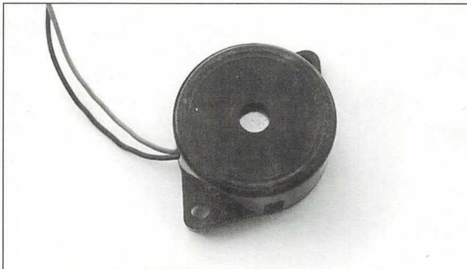
Oltre alla segnalazione ottica, il nostro metal-detector può avvisare acusticamente del rilevamento di un oggetto metallico; l'avviso è ottenuto collegando al circuito un semplice cicalino piezo.
