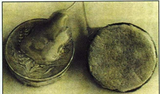
Come elettrodi si possono utilizzare delle monetine bloccando su di esse il conduttore mediante colla termofusibile.
