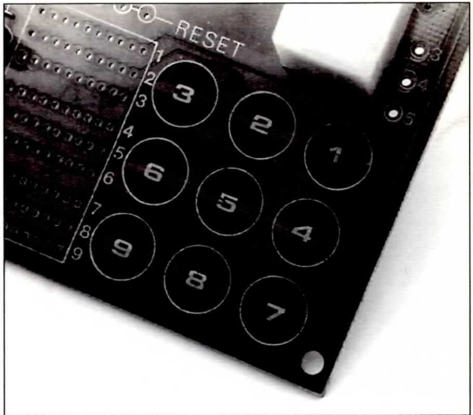
Il circuito della chiave elettronica dispone di 9 coppie di contatti utilizzabili come interruttori "a tocco" oppure collegabili ad una tastiera formata da 9 pulsanti normalmente aperti.
