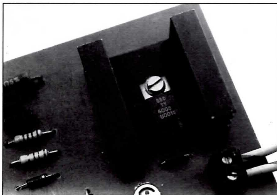
L'SCR TY1 (8-10 ampère) va montato su un dissipatore avente resistenza termica di non più di 10 °C/W. L'altro SCR non richiede dissipatore; va montato con il lato metallico rivolto ad R1.
