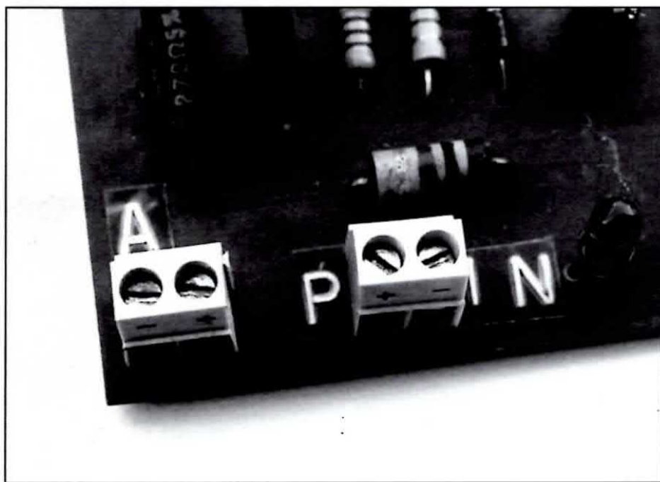
Il circuito dispone di due morsetti (li vedete marcati con "A" nella fotografia qui sopra) per inserire un amperometro, strumento che indicherà di volta in volta la corrente fornita alla batteria.
