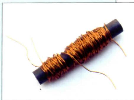
La doppia bobina va realizzata avvolgendo 120 spire per L1 e 43 per L2; va usato filo di rame smaltato da 0,3mm.
