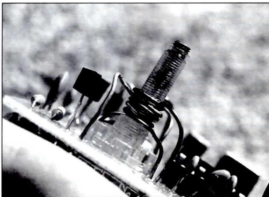
**Le due bobine vanno realizzate su appositi supporti in plastica con nucleo in ferrite avvvitabile; saldati i terminali delle bobine fissate i rispettivi nuclei (supporti) allo stampato con della cera.**
