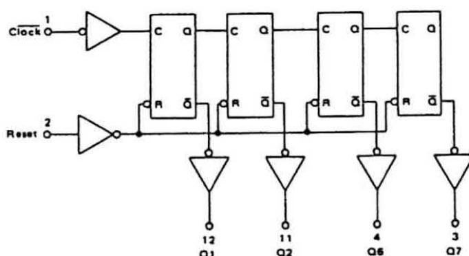
e manda basse le sette uscite, indipendentemente dallo stato dell'ingresso di clock. Come molti sanno, un contatore è un particolare tipo di rete digitale formata da "N" flip-flop opportunamente connessi e in grado di contare il numero degli impulsi (sino ad un massimo di  $2^N - 1$ )
