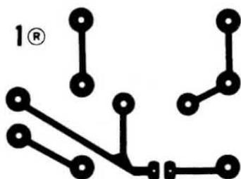
**Traccia al naturale del circuito stampato e disposizione componenti del primo circuitino.**
