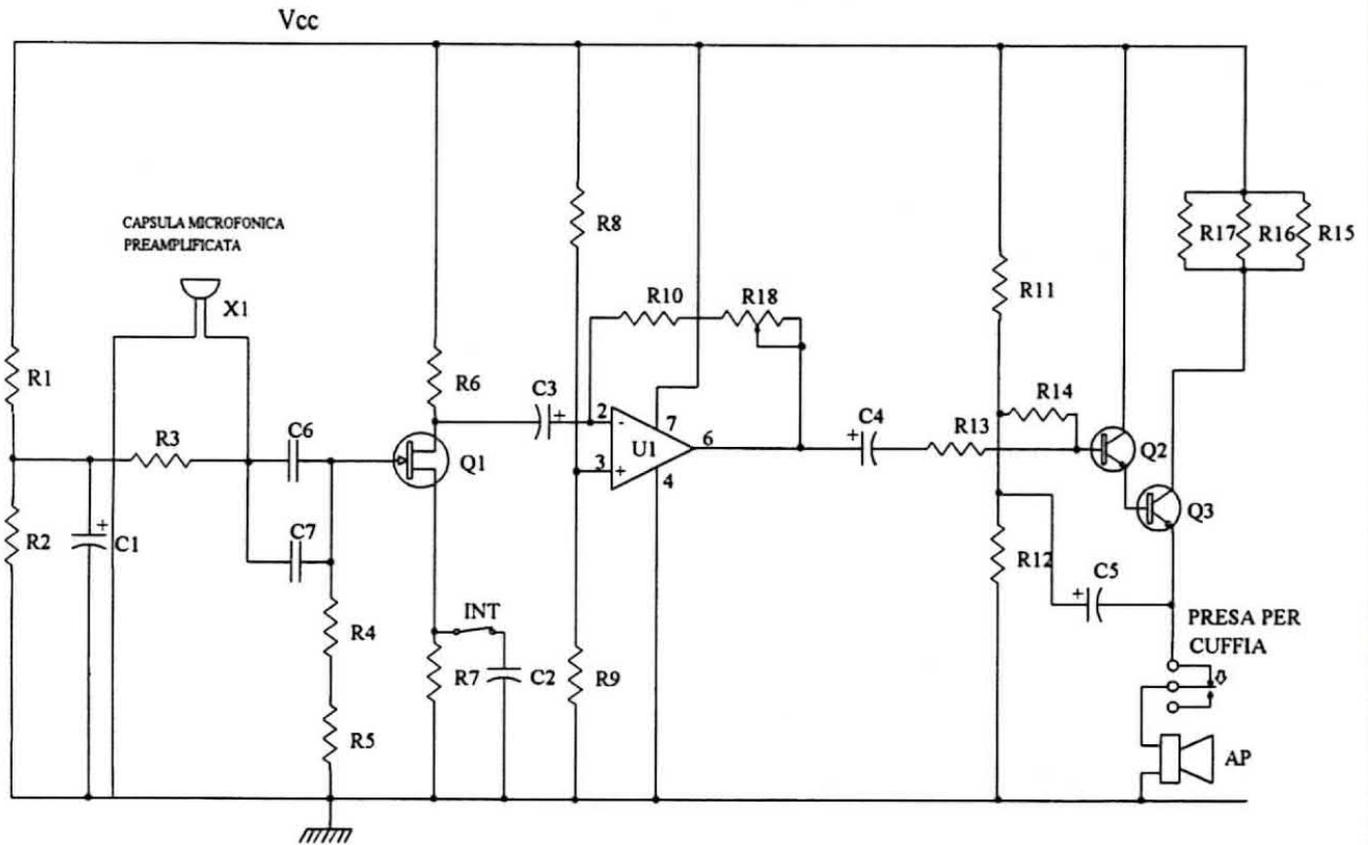
**Il circuito da realizzare: il segnale proveniente dal microfono viene applicato ad un FET ad elevata impedenza d'ingresso e poi amplificato.**
