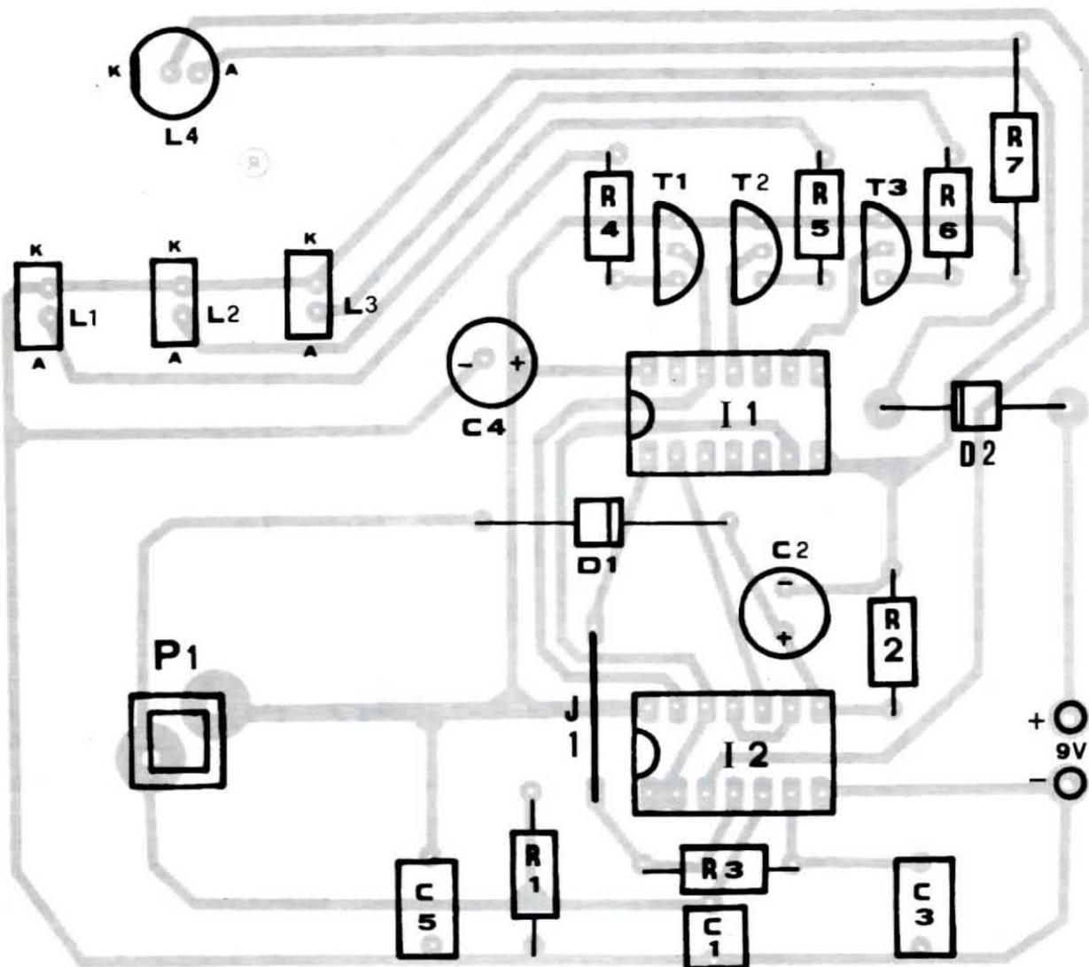
**Topografia dei vari componenti sulla basetta stampata. Non si dimentichi il ponticello, necessario per chiudere la continuità elettrica del circuito.**
