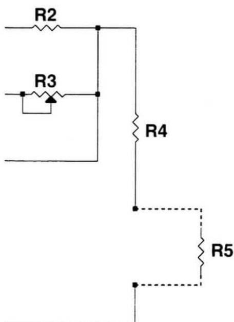
**Prima di collegare il modulo laser controllate, inserendo una resistenza da 33 Ohm (R5), che ai capi di R4 ci sia una c.d.t. di 750mV (agire sul trimmer R3 sino a leggere 750mV!).**
