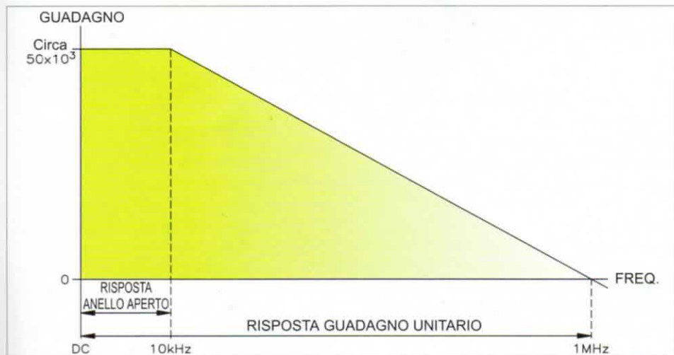
Grafico della banda passante rapportato al guadagno di un operazionale 741
