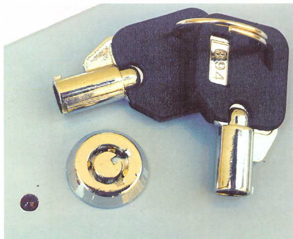
Sopra: lo schema di cablaggio dei componenti esterni alla basetta. Al centro: il montaggio in sezione dello stampato e dell'interruttore a serratura. Sotto: un dettaglio della serratura e delle chiavi; occhio a non perderle perché non si fanno duplicati (si deve cambiare tutto l'insieme!)
