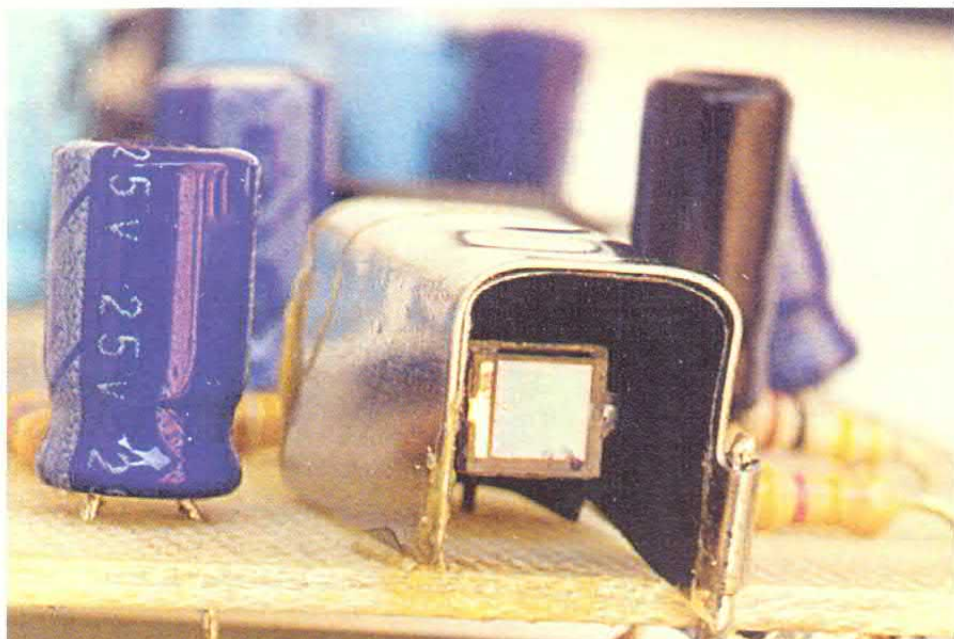
Il fotodiode, all'interno della cavità metallica appositamente annerita.
