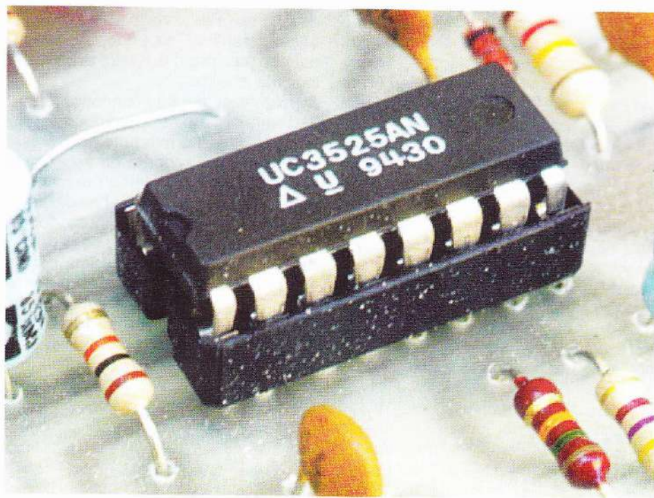
L'integrato 3525: un perfetto e completo driver PWM che genera impulsi rettangolari con duty cycle variabile in funzione di una tensione di riferimento.
