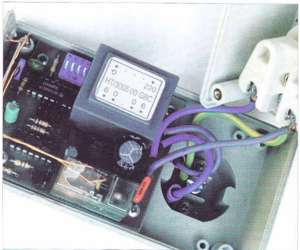
Il ricevitore in un contenitore con spina e presa asservita per 220V.
