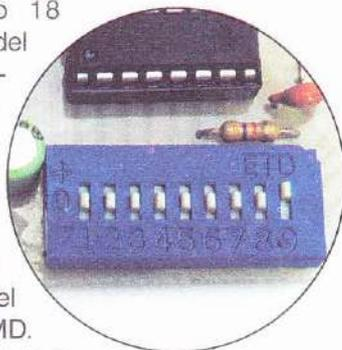
Per completare l'opera innestate i chip nei loro zoccoli, avendo cura di tenerli rivolti il CD4013 con la tacca che guardi all'ibrido e l'MC145026 verso il CD4013: la disposizione componenti mostra inequivocabilmente come orientare i due integrati dual-inline. Ora il ricevitore è pronto per l'uso, non avendo nulla da tarare: l'unica cosa che va regolata è la combinazione dei 9 bit di codifica, ciascuno dei quali può
