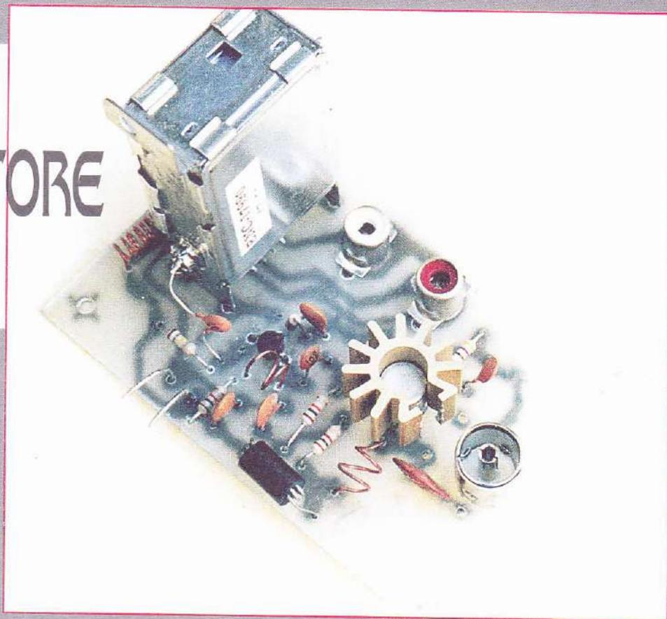
*Per costruire il vostro primo TX per i canali TV, con il quale potete vedere e sentire in qualsiasi televisore in bianco e nero o a colori le immagini di una telecamera o il contenuto di una cassetta letta da un videoregistratore, il tutto senza alcun filo di collegamento. Il progetto è apparso su Elettronica 2000 in Aprile 1999.*
