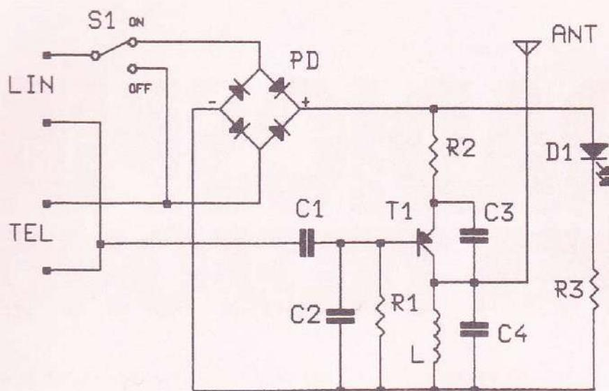
Il circuito, come si vede semplice, è costituito da un oscillatore a transistor. L'alimentazione è la stessa già presente sulla linea.
