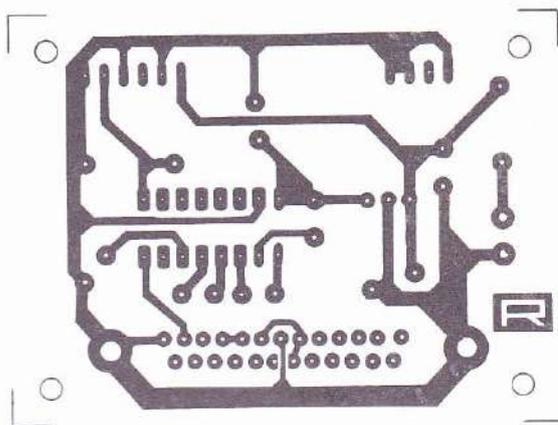
Il circuito stampato del trasmettitore in scala 1:1
