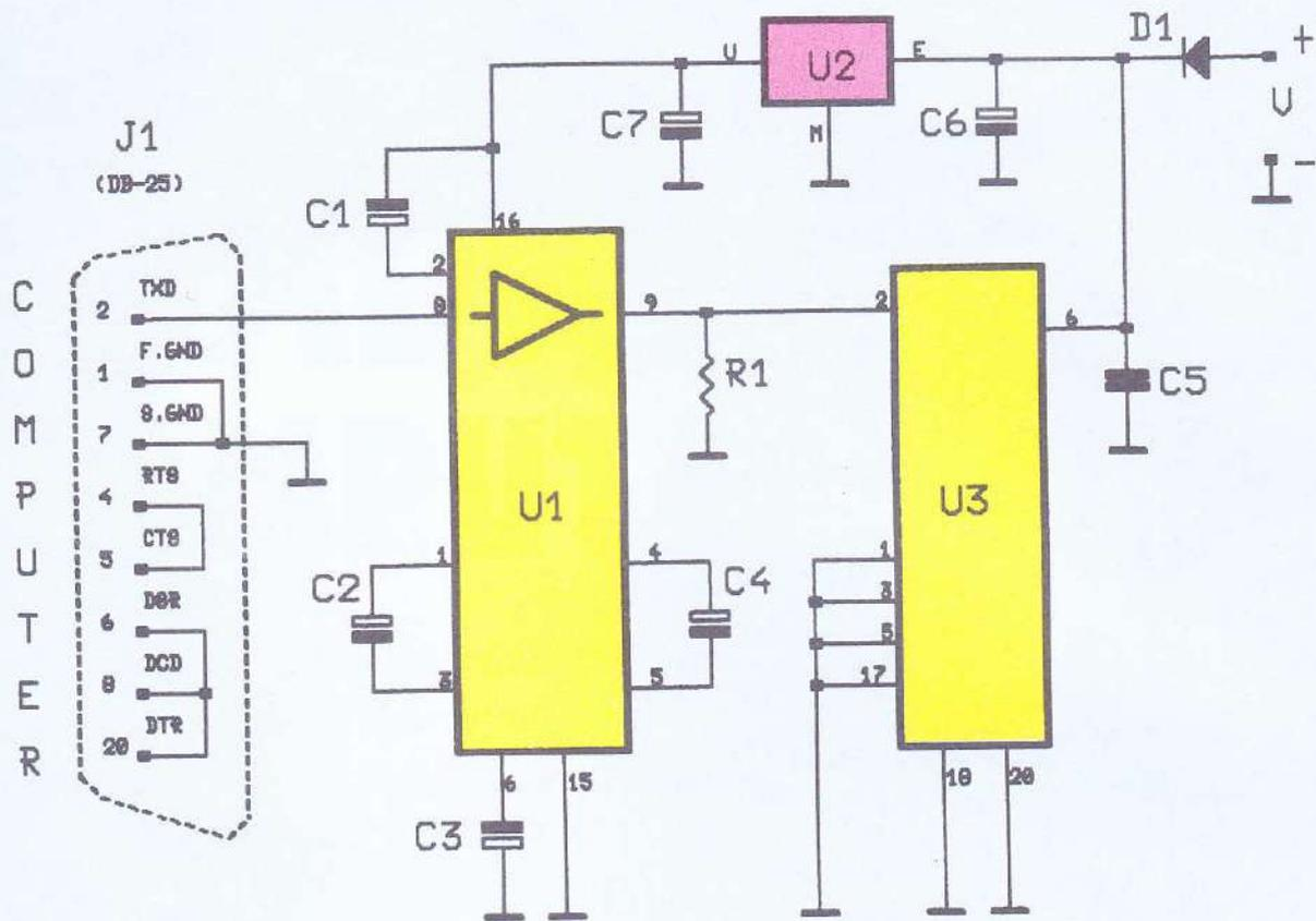
Il circuito utilizzato per la trasmissione dei dati: solo un ibrido e un convertitore seriale per risolvere tutto.
