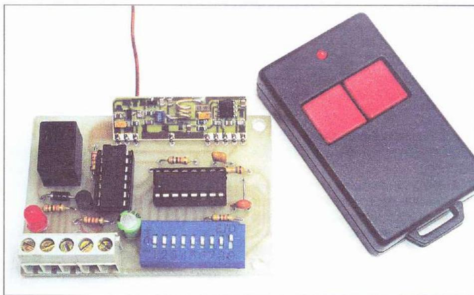
*Ricevente universale per trasmettitori con codifica Motorola MC145026, provvisto di uscita bistabile a relé capace di commutare carichi da 1 ampère a 250 Vac. Disponibile in kit di montaggio.*
