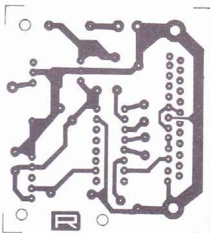
Il circuito stampato del ricevitore in scala 1:1
