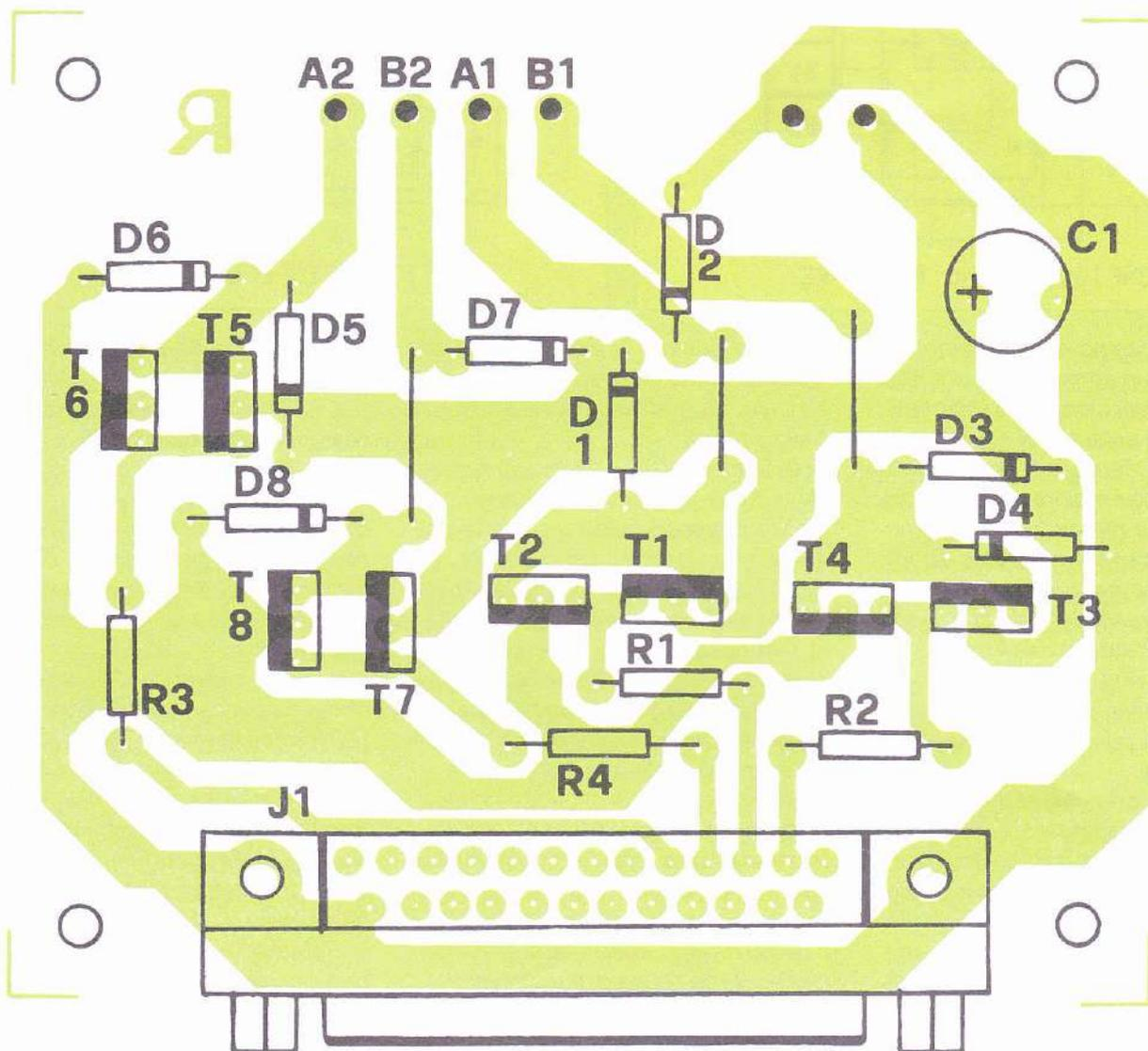
Disposizione dei componenti. Attenti all'alimentazione: conviene fornire una tensione continua di poco superiore a quella nominale richiesta dal motore passo-passo (es. 6 volt per uno stepper motor da 5 volt).
