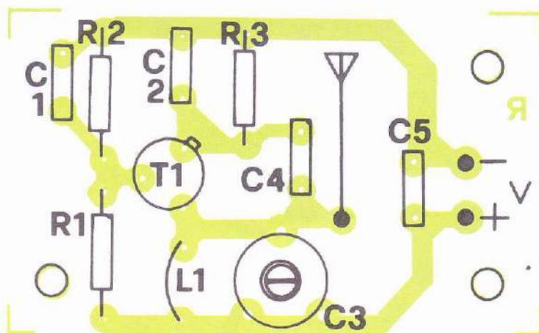
L1 e di capacità del compensatore C3 e di C4: si tratta di un NPN di tipo BFR36 studiato appositamente per lavorare in amplificatori e dispositivi ad RF, caratterizzato da una massima frequenza di transizione di 1,4 GHz a 70 mA di corrente di collettore; dissipa una potenza massima di 5 watt con radiatore, sebbene alle frequenze a cui lo usiamo non va oltre qualche decina di milliwatt.
