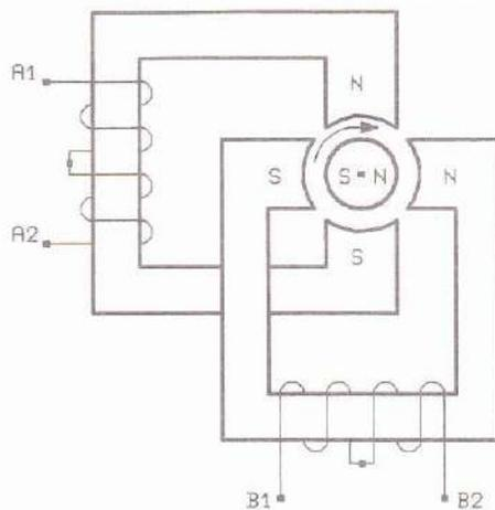
toratori a massa ed i collettori liberi, ponendo il centrale di ogni solenoide del motore al positivo d'alimentazione, un po' come si farebbe con un trasformatore avente il primario a presa centrale.
