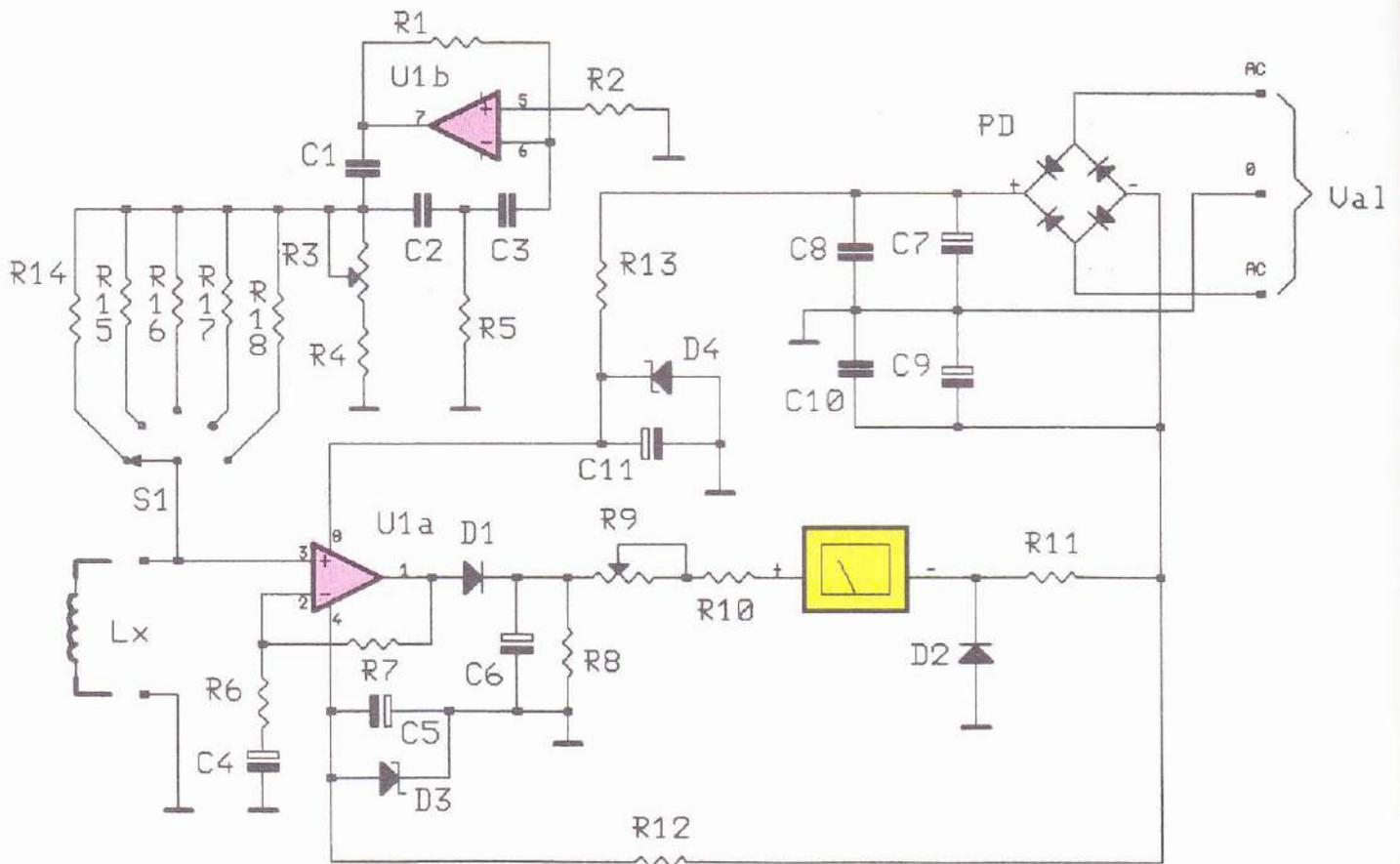
tanze (leggi bobine...) economico, affidabile e sufficientemente preciso, che potrà aumentare la vostra dotazione di laboratorio. Con esso possiamo misurare il valore di induttanze AF, BF, ma anche delle bobine per i filtri cross-over delle casse acustiche, quelle solitamente
