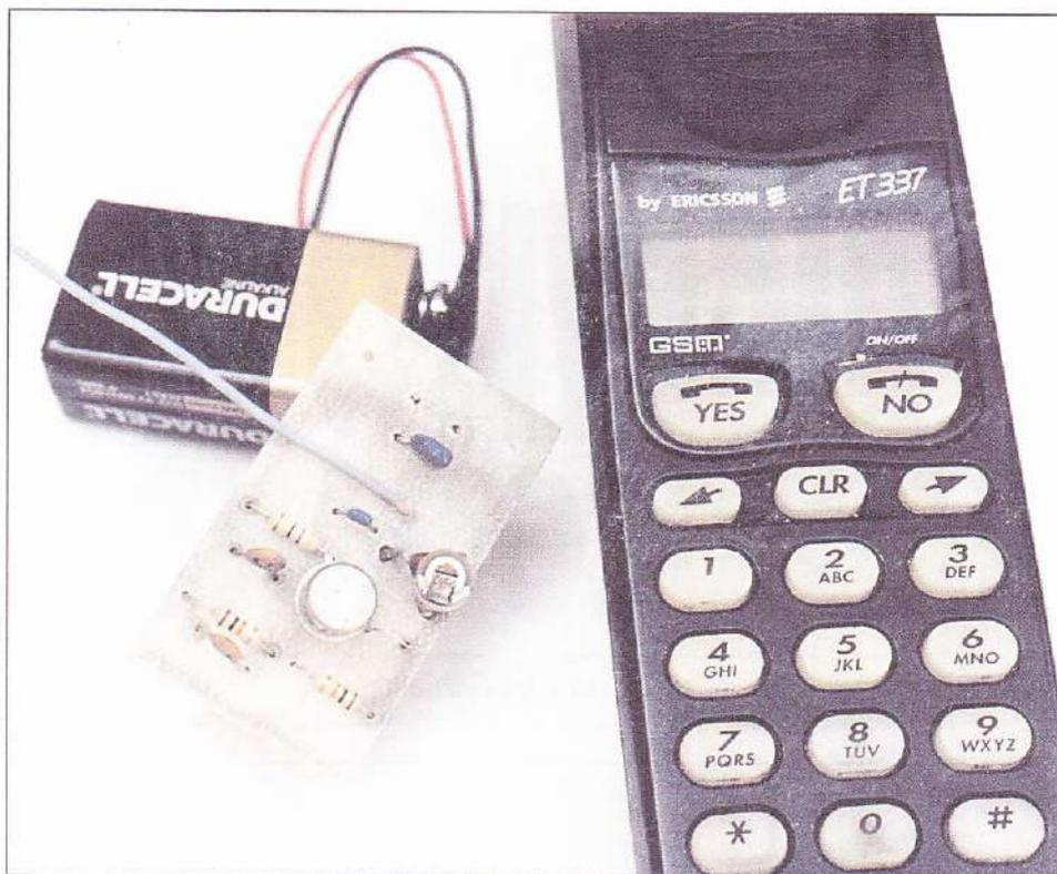
*Ricordarsi, nelle prove di funzionamento, di agire lentamente sul compensatore C3. Ciò per ottenere la massima stabilità.*
