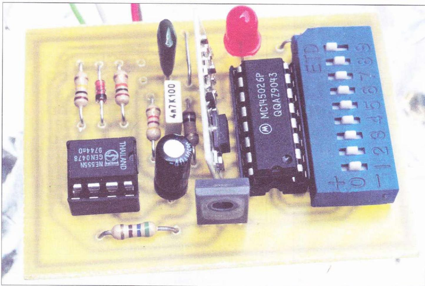
gresso dell'IC3, che è il modulino TX ibrido al quale è affidato il compito di trasmetterlo nell'etere tramite l'apposita antenna.
