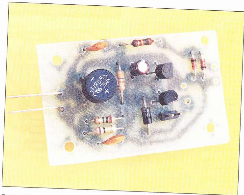
Bene, spiegato il funzionamento dell'interruttore rivelatore di sgancio, vediamo brevemente l'interfaccia di linea che permette di prelevare la fonia e mandarla all'ingresso del registratore: si tratta della rete composta dai condensatori di disaccoppiamento C2 e C3, dalla resistenza R4 e dalla coppia di diodi D2 e
