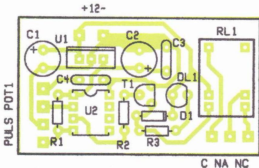
Traccia del circuito stampato in scala 1:1. A sinistra il montaggio dei vari componenti.
