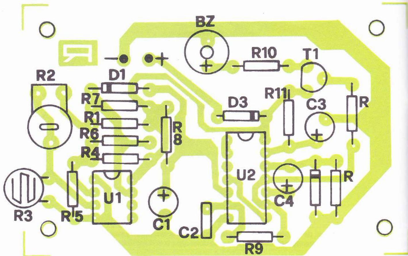
commuta allo stato alto e lascia interdire il transistor T1, tacitando il cicalino. Nello stesso istante anche il piedino 9 torna a livello alto e se l'8 è anch'esso ad uno l'uscita della U2c torna a zero e forza, tramite il diodo D2, la scarica rapida dell'elettrolitico C4. Questo corrisponde al reset, al ripristino del monostabile.
