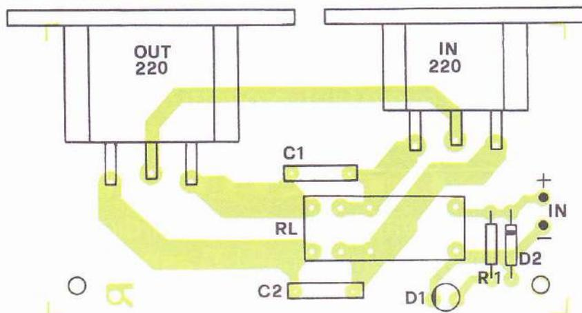
te, infilatevi i pochissimi componenti che servono, badando di disporre i diodi come illustrato negli appositi disegni (rammentate che in un diodo il catodo è il terminale vicino alla fascetta colorata sul corpo); per il LED, badate che il catodo è l'elettrodo posto vicino alla smussatura del contenitore, almeno per i LED tondi (per tutti gli altri è sempre il reoforo collegato all'elettrodo che all'interno si vede più grande).
