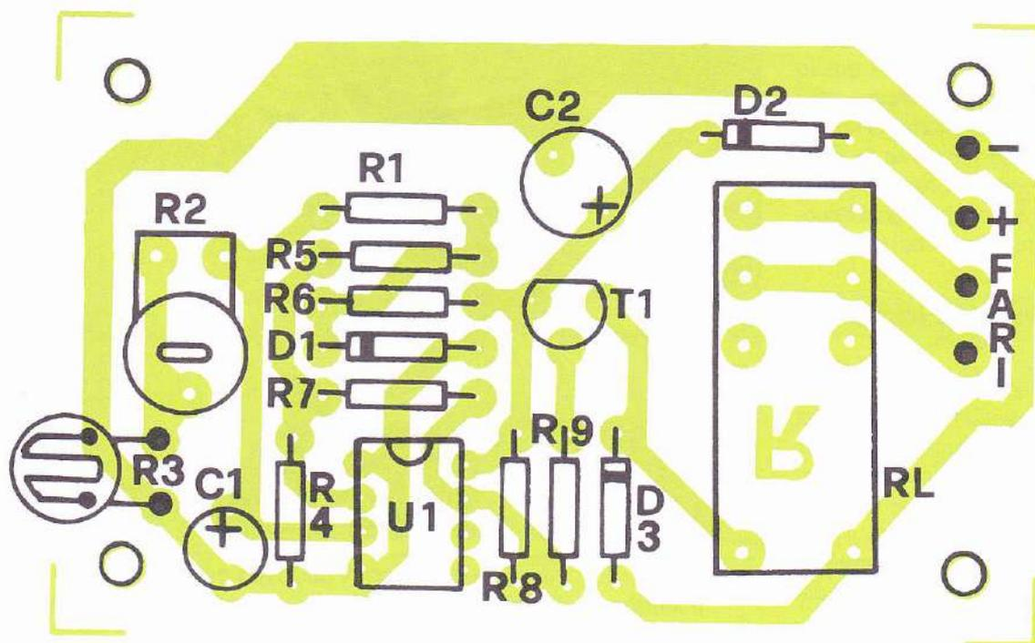
automatico intervenga. Per la taratura, ricordate che maggiore è la resistenza inserita (cursore ruotato in senso orario) meno deve essere buio per far scattare il relè; viceversa, ruotando il cursore nel senso contrario (cioè diminuendo la resistenza in serie al fotoresistore) occorre che la luce nell'ambiente sia sempre di meno.
