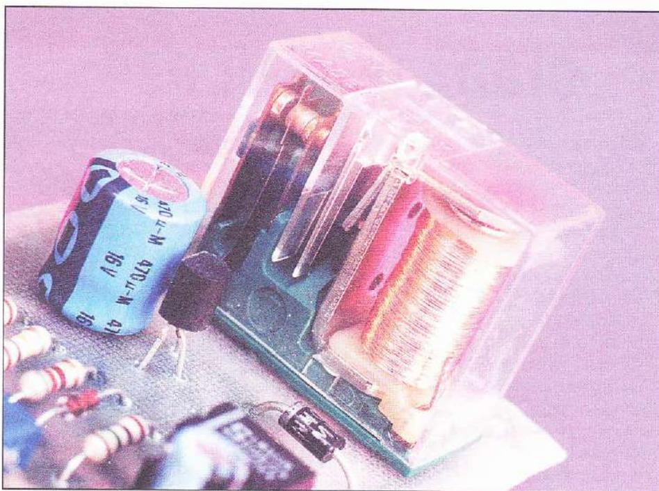
*Il relè a due scambi utilizzato nel prototipo.
