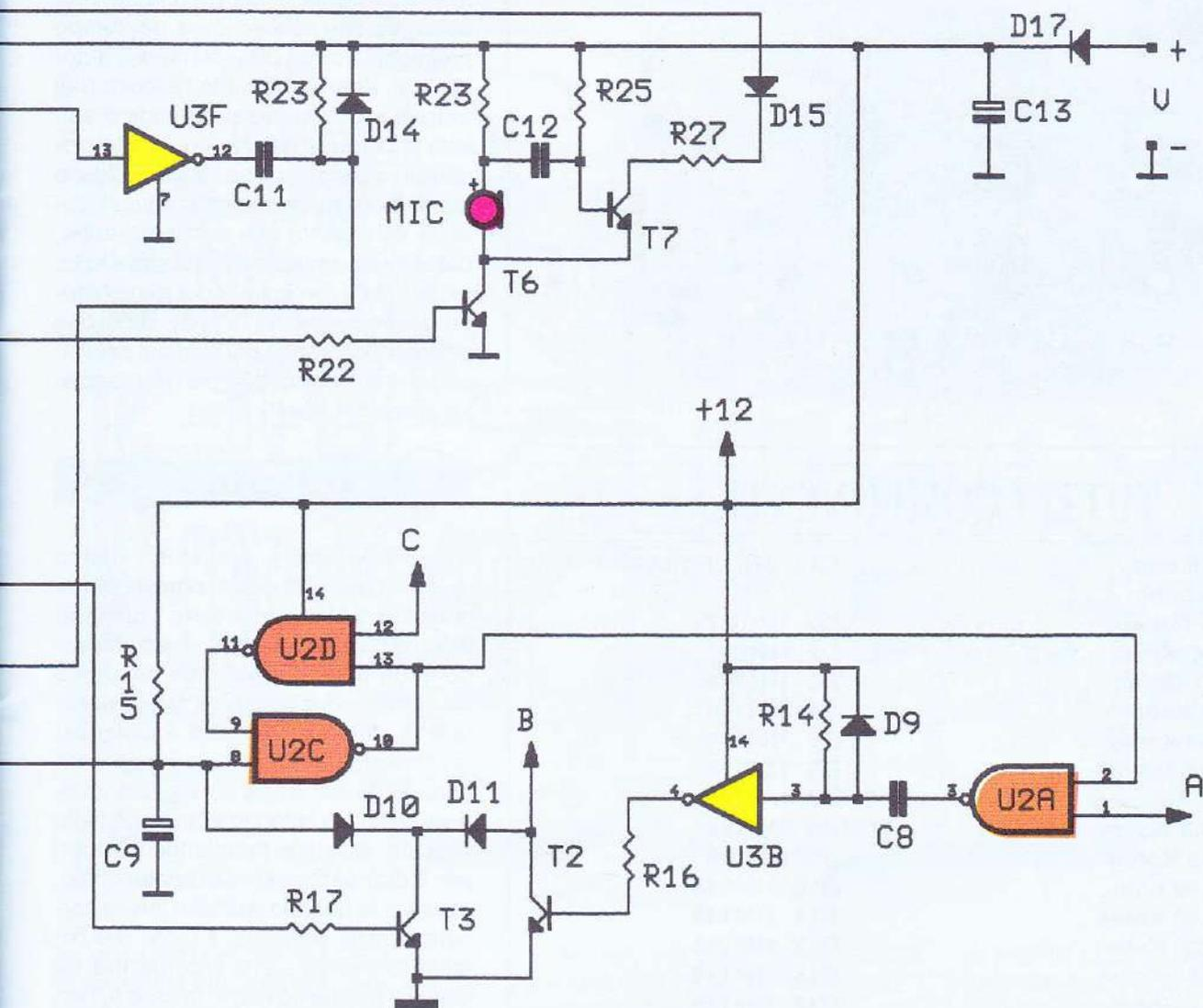
Questo ha costretto i progettisti di sistemi di intercettazione ambientale a rivedere un po' le cose, perché se prima l'infinity poteva essere un semplice microfono con traslatore di linea e rilevatore di sgancio, a partire dal momento in cui la rete telefonica è stata modificata, il dispositivo ha dovuto fornirsi di qualcosa in più: un temporizzatore che
