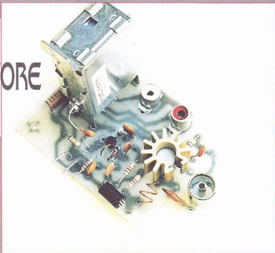
*Per costruire il vostro primo TX per i canali TV, con il quale potete vedere e sentire in qualsiasi televisore in bianco e nero o a colori le immagini di una telecamera o il contenuto di una cassetta letta da un videoregistratore, il tutto senza alcun filo di collegamento. Il progetto è apparso su Elettronica 2000 in Aprile 1999.*
