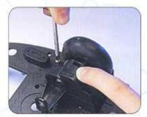
Prendi la sezione superiore con la mano libera e collocala sopra quella centrale. Tieni insieme il tutto premendo sulla parte superiore mentre inserisci le due viti. Quando disporrai del prossimo componente dovrai rimuovere le viti per inserire il motore, quindi non stringerle troppo.
