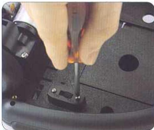
**2** Gira il telaio e avvita le due viti autofilettanti più piccole sul lato inferiore del vano per l'interruttore, in modo da bloccare l'interruttore. ◀
