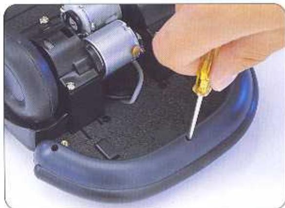
**6** Usa tre viti per fissare il paraurti posteriore al telaio. Se i paraurti sono montati correttamente, i fori delle viti sui paraurti si troveranno al di sotto del robot. ◀
