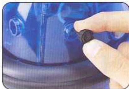
**3** Inserisci il connettore che si trova all'estremità del cavo bianco nella presa bianca sulla scheda I/O del sonar posta di fianco allo switch rosso. La presa per il trasmettitore sinistro ha la sigla L-TX. Il connettore può essere inserito in un unico modo: non forzarlo, ma accertati che sia collegato perfettamente. ▼
