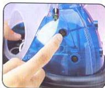
**6** Inserisci il connettore del ricevitore nella presa con la sigla R-RX sul lato destro della scheda I/O del sonar. Il cavo verde non deve essere bloccato, ma deve pendere liberamente. ▶
