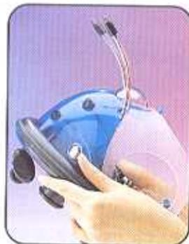
**3** Quando Cybot è tenuto sollevato in uno spazio aperto non dovrebbe 'vedere' niente. Ti accorgi se riconosce un oggetto perché i LED verdi sulla punta delle antenne lampeggiano e le ruote cambiano direzione (in uno spazio aperto, le ruote dovrebbero entrambe muoversi in avanti). ▶
