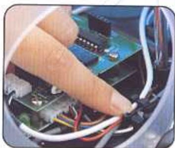
**5** Ripeti il punto 1 per il ricevitore del sonar, quello con il cavo VERDE. Inserisci il cavo e il connettore nel foro superiore dello scudo frontale destro di Cybot (visto dal retro). Spingi delicatamente il trasmettitore all'interno del foro fino a fissarlo saldamente. ▶
