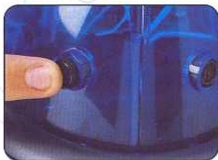
**3** Inserisci il connettore che si trova all'estremità del cavo bianco nella presa della scheda I/O del sonar, con la sigla R-TX, che si trova a destra della presa utilizzata in precedenza per il trasmettitore sinistro. ▼
