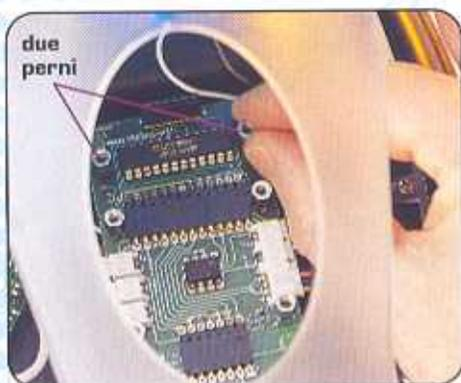
**4** Svita e metti da parte i due perni di metallo che fissano la scheda del processore di luce al telaio (potresti aver bisogno di una chiave da 5 mm o di pinze a becco lungo). Non perdere i due piccoli dadi che fissano i perni sotto il telaio. ◀
