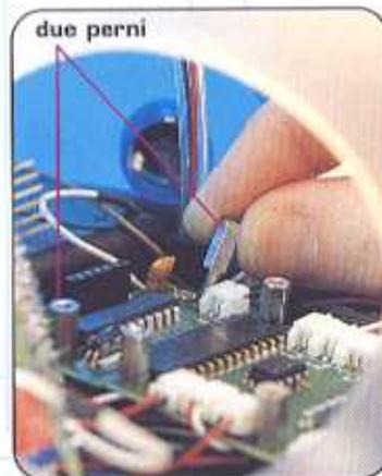
**8** Reinserisci la scheda del processore del sonar (uC2), con la scheda I/O del sonar sempre attaccata, nella scheda del processore di luce sottostante. Accertati che il pin 1 vada nella presa 1 e il pin 6 nella presa 6, in modo che le schede siano allineate. ▶
