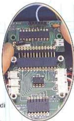
**7** Fissa la scheda del processore di luce potenziato al telaio, utilizzando i due perni di metallo messi da parte al precedente punto 4, facendo attenzione ad avvitarli bene ai due piccoli dadi sotto il telaio. ▶
