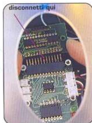
**6** Innesta la scheda del processore di luce potenziato (uC1) fornita con questo fascicolo, assicurandoti che il pin 1 venga inserito nella presa 1 della scheda I/O di luce; e il pin 13 nella presa 13. ▶
