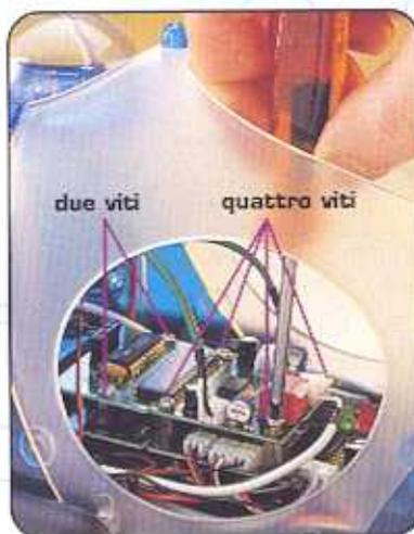
**9** Fissa nuovamente sia la scheda I/O del sonar sia la scheda del processore del sonar ai sei perni di metallo utilizzando le viti messe da parte ai punti 1 e 2 della pagina precedente. Posiziona l'interruttore di Cybot su ON e verifica tutte le modalità (vedi box a sinistra). ◀
