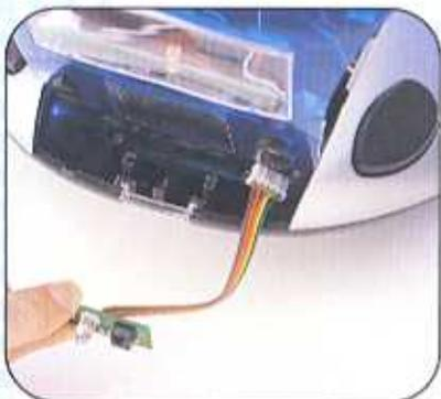
**4** Infila la scheda del trasmettitore IR nella struttura di sostegno tra lo speaker e la copertura per gli infrarossi. Il sensore PIC nero e il LED bianco devono essere rivolti all'esterno, verso la copertura per gli
