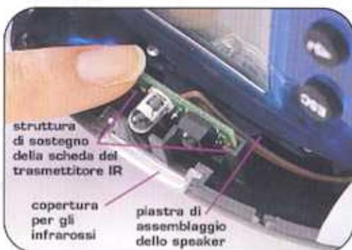
infrarossi. Accertati che la scheda del trasmettitore IR sia posta correttamente, in modo che il LED bianco sia in corrispondenza dell'alloggiamento arrotondato a U sulla parte anteriore della base nera del telecomando. Introduci accuratamente il cavo piatto multicolore tra la scheda del trasmettitore IR e la piastra nera di assemblaggio dello speaker. ◀
