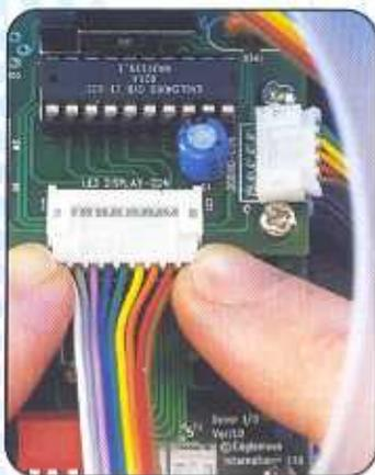
**9** Inserisci il connettore bianco, posto sulla parte terminale del cavo piatto multicolore della scheda del display digitale sul pannello posteriore di Cybot, nella presa a 9 pin contrassegnata LED DISPLAY-CON. ◀
