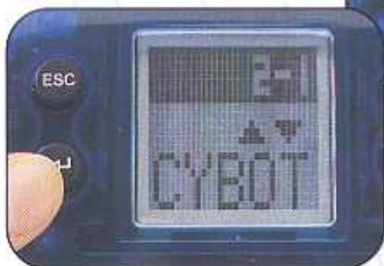
**3** Premi ancora Invio per andare al selettore dei canali. La linea superiore mostra da 2-1-1 a 2-1-16 a seconda del canale selezionato (da 1 a 16). Per selezionare un canale a scelta, utilizza il pulsante freccia su o giù e fai scorrere i canali dall'1 al 16. Fermati al canale prescelto, per esempio 8. In questo caso sul tuo display in alto apparirà 2-1-8. Per impostare il canale premi ESC. ▲ ▶
