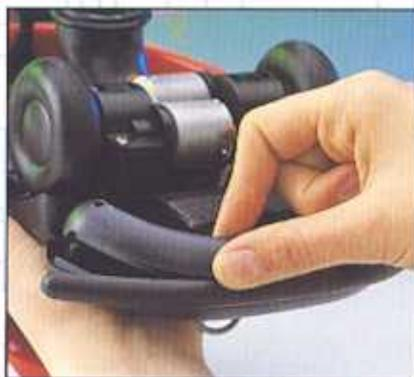
**2** Solleva e rimuovi la sezione inferiore del paraurti e la striscia di gomma interna. ▲
