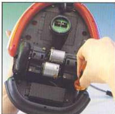
**5** Rimuovi le due piccole viti che fissano la scheda del display digitale al pannello posteriore, ma fai attenzione a non scollegarla dalla scheda uC3 del robot. ▶
