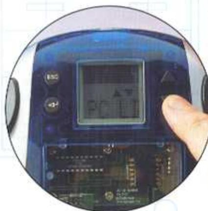
**2** Usando il pulsante Invio e le frecce per muoversi nel menu principale, seleziona **4 CONNESSIONE AL COMPUTER** sul telecomando (nella foto, la versione in inglese). ◀
