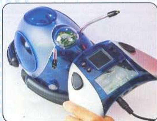
**1** Controlla che Cybot e il suo telecomando siano accesi e che il selettore di canale di Cybot sia impostato sul canale predefinito, il canale 1. Metti Cybot entro il raggio d'azione del telecomando (8-10 cm). Nota: a questo stadio dell'operazione, Cybot può anche stare sul tavolo del computer se il cavo seriale non è abbastanza lungo per usare il telecomando al livello del pavimento. ▶
