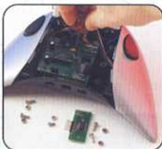
**4** Svita la scheda di interfaccia uC1 e riponi le quattro viti e i quattro dadi in un luogo sicuro. *Nota:* dovresti avere due viti lunghe per il lato sinistro della scheda e due corte per la parte centrale. ◀
