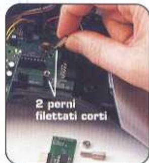
**5** Usa i due perni filettati corti forniti nel fascicolo 47 per fissare la parte centrale della scheda, usando due dadi originali all'interno del vano batteria. ◀
