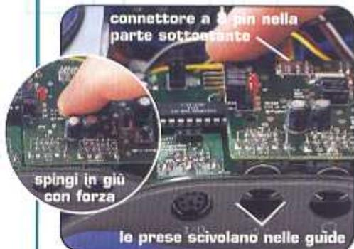
**9** Posiziona la scheda di riconoscimento vocale uC2 sui tre perni, con il microchip nella parte inferiore. Fai scivolare i due box delle prese nelle guide all'interno del telecomando. Spingi la scheda nella presa uC2-CON a 8 pin situata sulla scheda uC1 sottostante. ◀
