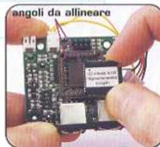
**4** Premi con forza sul microchip in modo che tutti e quattro i lati si inseriscano con esattezza nell'alloggiamento (nelle foto, la versione inglese). ◀
