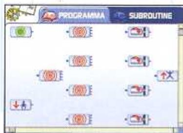
**5** Connetti i blocchi usando il mouse esattamente come mostrato. Una buona idea è quella di assegnare colori diversi alle linee, usando il pannello Colore linee. ▲
