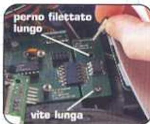
**6** Rimonta la scheda EEPROM. Per il foro anteriore usa il perno filettato lungo fornito nel fascicolo 47; per il foro posteriore usa la vite lunga originale (la scheda uC2 necessita di soli tre perni di sostegno). ◀
