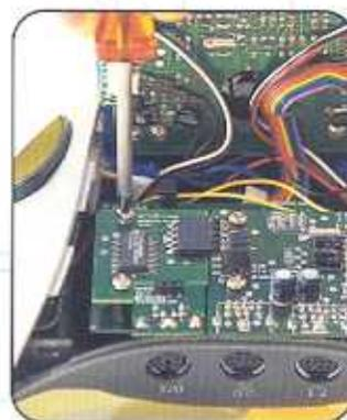
**5** Fissa la scheda della memoria flash ai perni sottostanti usando le due viti corte fornite in questo fascicolo. ◀
