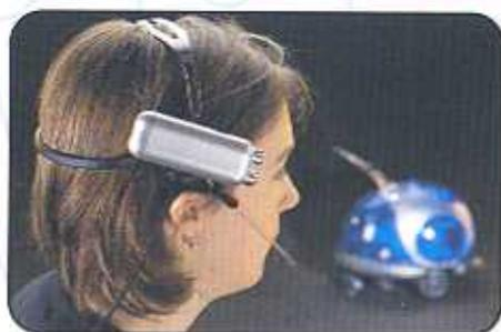
**3** Cybot emetterà un suono, poi si muoverà verso la tua torcia. Sposta la testa per creare un obiettivo mobile che il robot possa seguire. Mantieni la testa orientata verso Cybot, sia per trasmettere dati via IR sia per puntare la torcia davanti a Cybot. ◀
