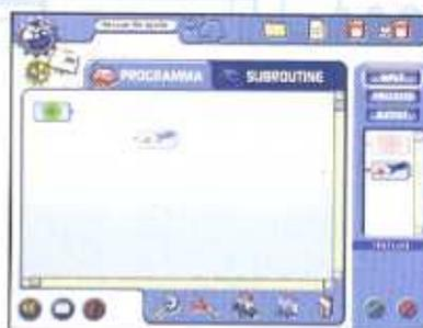
**3** Ora seleziona un altro blocco Luce e un altro blocco Motore. Questa volta regola Motore su S=2, D=-2 (gira verso destra in cerchio) e ordina al blocco Luce di accendere i LED dell'antenna. ▼
