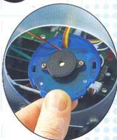
**4** Svita lo speaker piezoelettrico dalla parte inferiore del supporto superiore e lascialo al sicuro all'interno di Cybot. ▶
