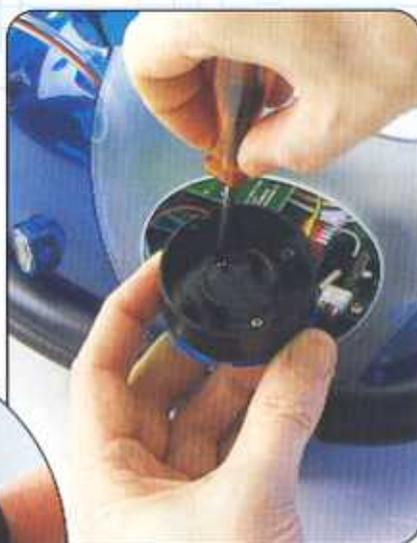
**2** Tenendo lo speaker conico per i bordi, posizionalo nel suo alloggiamento con il magnete rivolto verso il basso (la parte conica rivolta verso l'alto). Fai passare all'esterno i due fili attraverso la tacca sul lato sinistro. ▼
