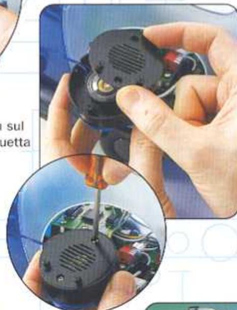
**4** Utilizzando due viti, fissa lo speaker piezoelettrico originario ai perni della piastra. *Nota:* lo speaker piezoelettrico deve trovarsi sul bordo anteriore della sezione di supporto superiore, in modo che risulti posizionato davanti alle schede all'interno di Cybot. ▼
