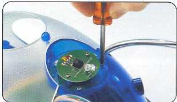
**3** Abbassa la sezione del supporto superiore (con attaccata la scheda del ricevitore IR) all'interno di Cybot ed estraila lateralmente. NON scollegare nessun cavo (solo nel caso in cui alcuni cavi siano attorcigliati potresti trovarti nella necessità di scollegarne qualcuno). Capovolgila con delicatezza la sezione di supporto superiore. ▶
