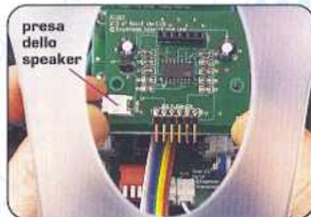
**2** Avvita i perni nei fori appena scoperti per rifissare la scheda uC4 e fornire un supporto per la nuova scheda uC5. ▶
