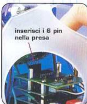
**5** Usa le due piccole viti messe da parte al punto 1 per fissare la scheda uC5 alla scheda uC4 (vedi box giallo nella pagina precedente). Nota: una spina a 6 pin è ora rivolta verso la parte posteriore del robot, pronta per il montaggio della scheda di memoria flash fornita col numero 52. Rimonta i tre pannelli flessibili blu. ▶
