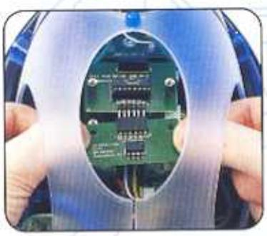
**5** Svita i due perni che fissano la scheda di controllo per i programmi uC4 ed estraila dalla presa della scheda uC3 sottostante. La scheda uC4 originale non sarà più necessaria. ▶
