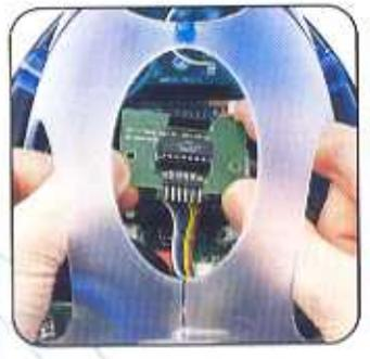
**6** Prendi la scheda di controllo per i programmi uC4 aggiornata e inserisci con cautela i pin sulla sua parte inferiore nella presa posta nella parte anteriore della scheda uC3. Controlla che tutti i pin entrino correttamente, quindi rimonta i due perni. ◀ ▶
