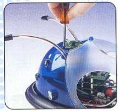
**10** Riasssembla con molta attenzione tutte le componenti smontate per questa operazione: la sezione del supporto superiore, la cupola e i pannelli flessibili. ◀
