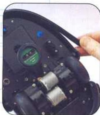
**2** Sistema la nuova striscia di gomma lungo il bordo interno della sezione superiore del paraurti. ▲
