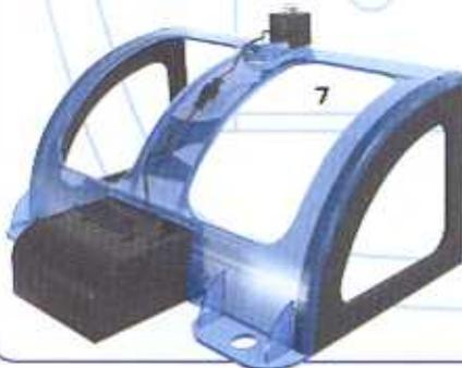
**7 PORTA:** un segnalatore a infrarossi agganciato alla traversa consente a Cybot di individuare la porta. Un vano batterie nella parte posteriore della base fornisce l'alimentazione e mantiene stabile la struttura.
