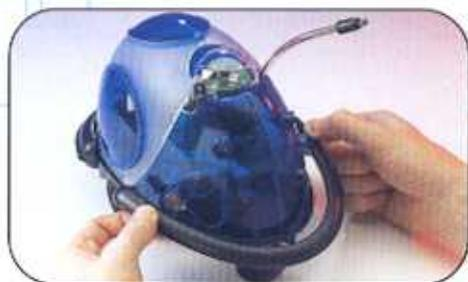
**3** Estrai la sezione superiore del paraurti dai tre fori apposti nel telaio. Allarga il paraurti per sollevarlo ed estrarlo senza urtare i due alloggiamenti dei sensori di luce sugli scudi frontali. ▲
