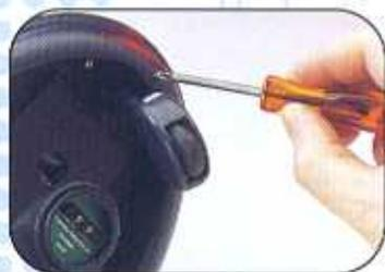
**2** Estrai la sezione inferiore del paraurti e la striscia di gomma. ▽
