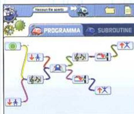
**2** Collega i blocchi come mostrato. Con questo programma puoi trasmettere a Cybot il comando di ripetere più volte la melodia (stando fermo) e, azionando un pulsante sul telecomando, di girare in senso orario, in silenzio. ◀
