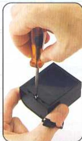
**8** Fissa il coperchio del vano batterie con la vite rimanente. ▲
