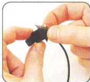
**3** Per posizionare il segnalatore dove vuoi, inserisci la sua linguetta in una delle fessure sul vano batterie. ▶
