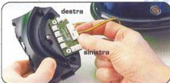
**4** Inserisci il connettore dei due cavi blu della scheda del microinterruttore del braccio sinistro nella presa a due pin ARM-L. ▼
