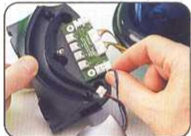
**5** Inserisci il connettore dei cavi (blu, nero e rosso) della scheda del ricevitore IR del braccio sinistro nella presa a 3 pin RX-L. ▲
