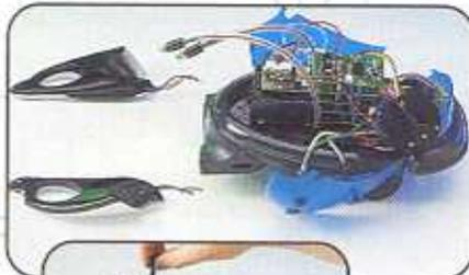
**4** Rimuovi i due bracci, facendoli scorrere in avanti, e l'alloggiamento del kicker, ruotando di un quarto di giro in senso antiorario i due tasselli,
