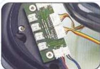
**3** Inserisci il connettore del cavo piatto a 5 fili proveniente dal lato destro della scheda uC6 nella presa posta in basso a destra della scheda del kicker. Ripeti l'operazione con il cavo proveniente dal lato sinistro. ▼
