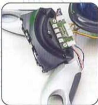
**6** Ripeti l'operazione con il braccio destro, inserendo il connettore dei due cavi blu nella presa ARM-R e il connettore degli altri tre nella presa RX-R. ◀
