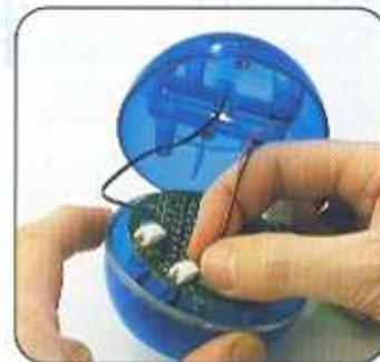
**3** Inserisci i cavi rosso e nero del vano batterie nella presa a 2 pin BAT-1 sulla scheda del controllore. ▲
