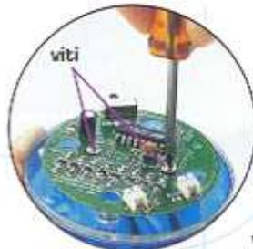
**4** Fissa saldamente la scheda ai perni con le due viti con rondella. ◀
