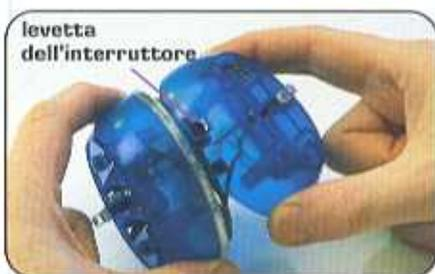
**4** Aggancia la metà del corpo blu con il foro alla levetta dell'interruttore (sulla scheda del controllore) in modo che la levetta sporga dal foro, poi unisci le due metà del corpo blu. ▲
