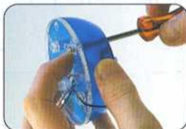
**6** Tenendo fermo con la punta del dito un dado nel suo alloggiamento, inserisci una delle viti lunghe nel perno blu corrispondente e avvitala bene al dado. ▲
