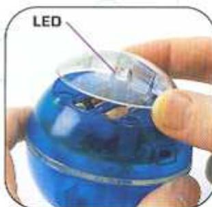
**2** Posiziona sopra le pile uno dei coperchi del vano batterie, facendo attenzione che la punta del LED entri nell'alloggiamento al centro del coperchio. ◀
