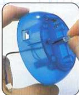
**2** Inserisci i cavi del LED del trasmettitore IR nella presa a 2 pin indicata TX-1 sulla scheda del controllore. ▼
