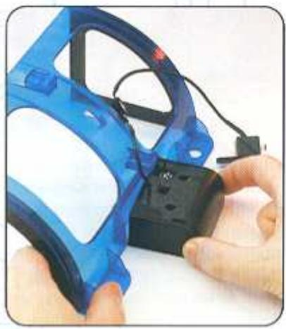
**3** Ruota il trasmettente IR in modo che il LED sia rivolto verso il basso, come mostrato. ▼
