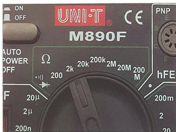
Selettore di misurazione di un multimetro: segnala le scale disponibili per la misurazione delle resistenze.
