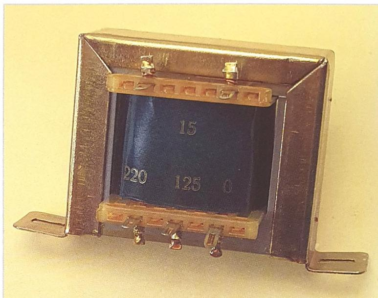
Trasformatore d'alimentazione con secondario da 15 Volt.
