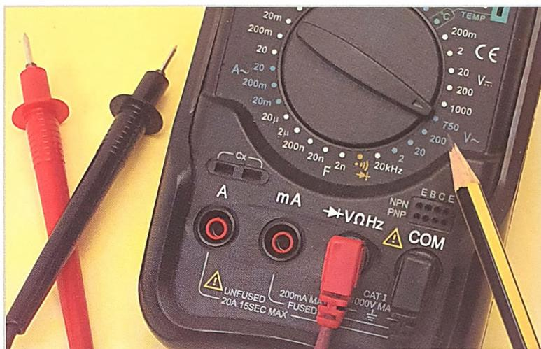
Prima di utilizzare un multimetro per misurare una tensione della rete, ci si deve assicurare che i puntali di misurazione siano uniti ai connettori adeguati, che il selettore delle scale sia su una portata adeguata alle tensioni alternate, e che ci sia come minimo un fondoscala di 750 V AC.
