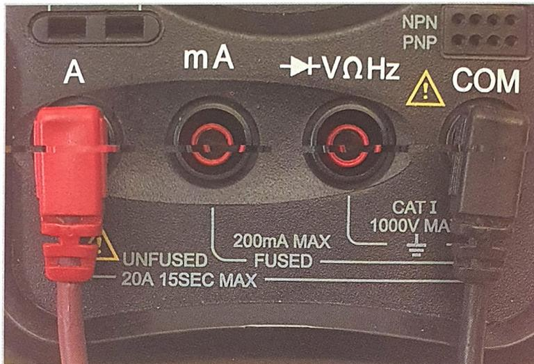
Connessione dei puntali di misura per la scala da 20 A; dobbiamo ricordarci che questa scala non è protetta da fusibile. Inoltre, non dovremo mantenere la connessione per più di 15 secondi.
