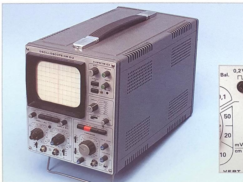
Oscilloscopio classico: è dotato di un tubo catodico di deflessione elettrostatica.
