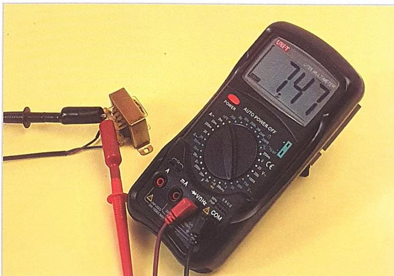
Misurazione di una tensione sulla scala più adeguata, quella da 20V.
