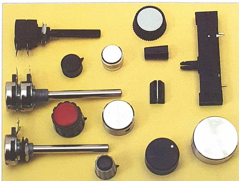
*I potenziometri a pannello vengono utilizzati per controllare una serie di parametri all'interno degli apparati. L'asse di comando viene poi tagliato su misura della manopola impiegata.*
