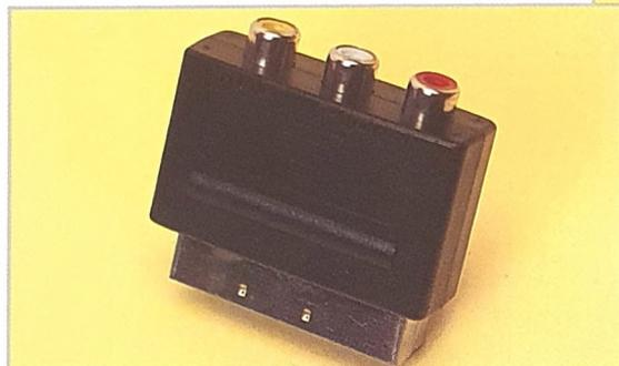
Adattatore RCA per euroconnettore. Si utilizza per collegare la telecamera a un euroconnettore: il connettore giallo è l'entrata video, quello bianco e quello rosso, invece, sono destinati ai due canali audio.
