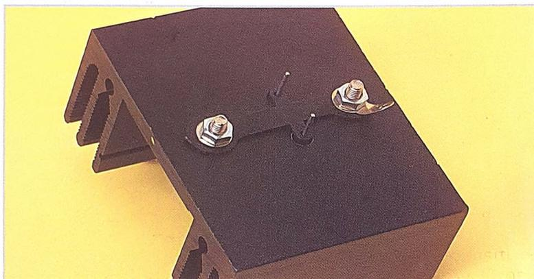
Transistor di potenza installato in un radiatore. Si osservi la collocazione degli accessori isolanti.
