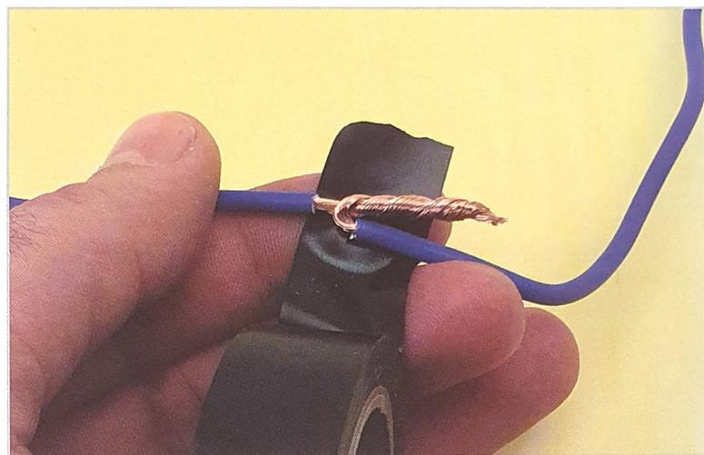
*Le connessioni effettuate arrotolando il cavo e isolandolo con del nastro isolante, sono una soluzione d'emergenza.*
