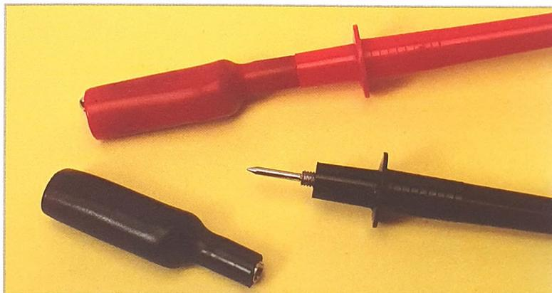
La connessione tra strumento e puntali di misurazione della tensione, si effettua con puntali di prova se la connessione è momentanea, oppure con delle pinze a coccodrillo se deve essere mantenuta per un periodo di tempo maggiore.
