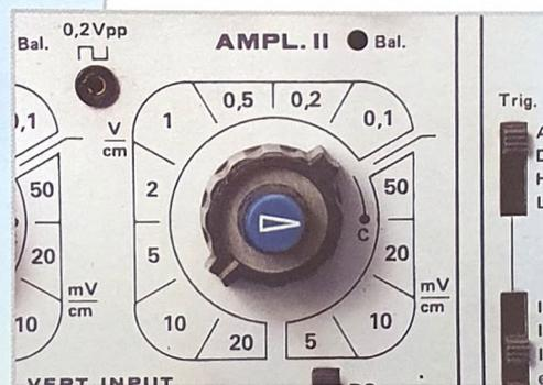
Selettore della sensibilità di un oscilloscopio classico.
