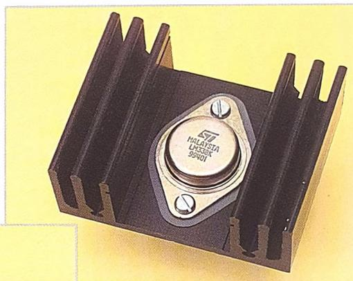
Quando la potenza da dissipare è molto elevata, si ricorre all'utilizzo dei dissipatori.
