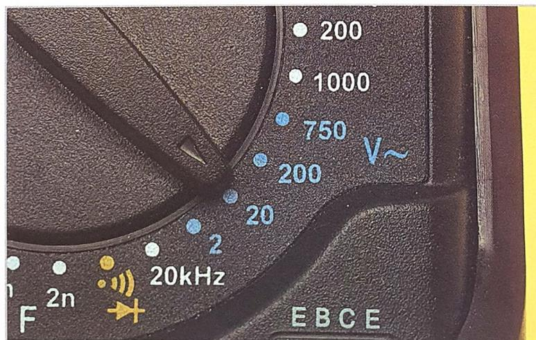
Prima di effettuare la misura, si deve selezionare la scala e ci si deve assicurare che sia quella delle tensioni alternate.
