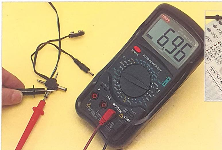
*Un'avaria molto frequente sono i guasti degli alimentatori: bisogna verificarne il funzionamento prima di aprire l'apparecchiatura.*
