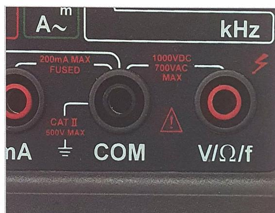
È importantissimo collegare i puntali di misurazione ai connettori COM e Ω, con quelli della misura della tensione.
