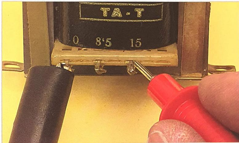
*Effettuare alcune connessioni utilizzando una pinzetta risulta utilissimo: così abbiamo una mano libera.*
