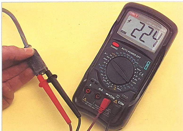
Misurazione della tensione della rete in un cavo di alimentazione di un'apparecchiatura.
