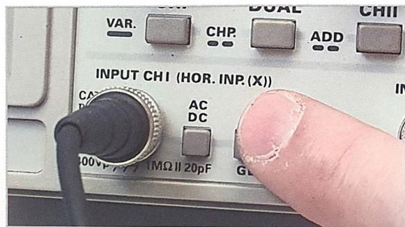
Il pulsante GD collega l'ingresso a terra per poter fissare il livello di riferimento utilizzato per le misure in continua.
