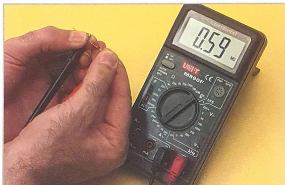
*Durante la misurazione, non si devono toccare le estremità delle resistenze: causerebbe un errore. In questo caso la resistenza è da 4M7.*
