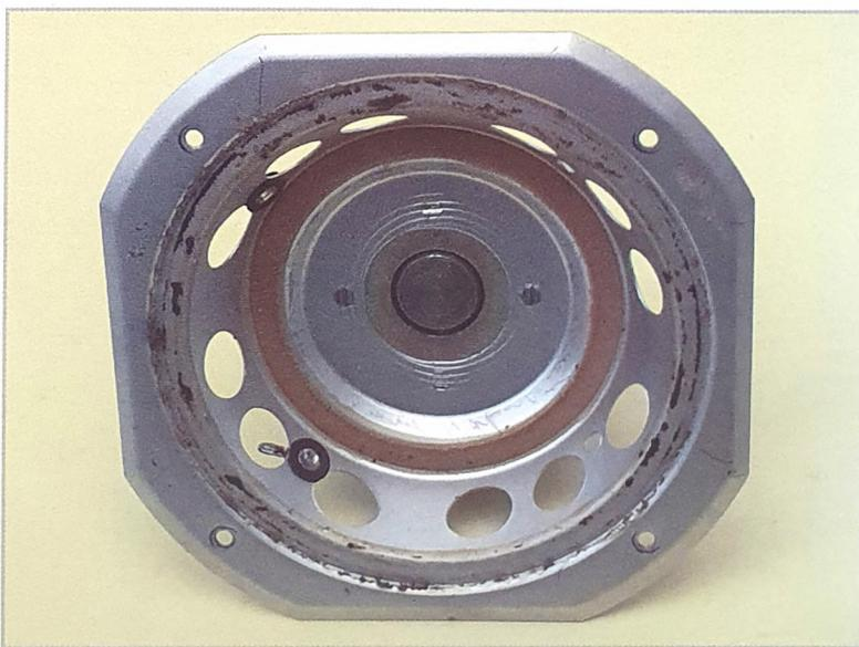
Anche la carcassa supporta le estremità polari del magnete; il circuito magnetico ne risulta interrotto da una stretta fessura che si chiama traferro.
