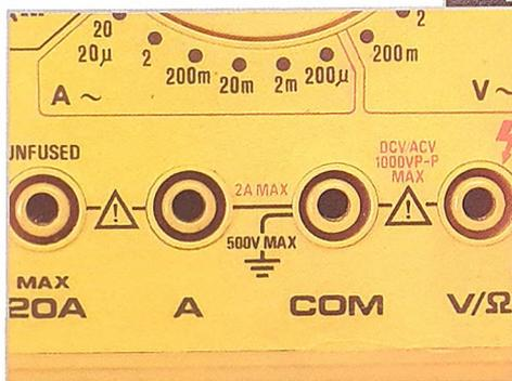
In questo modello di multimetro gli ingressi sono protetti dalla corrente fino a un massimo di 2 A.
