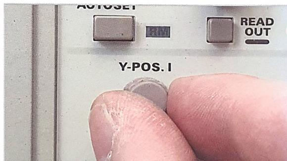
Il comando della posizione Y permette il posizionamento della linea orizzontale in senso verticale.
