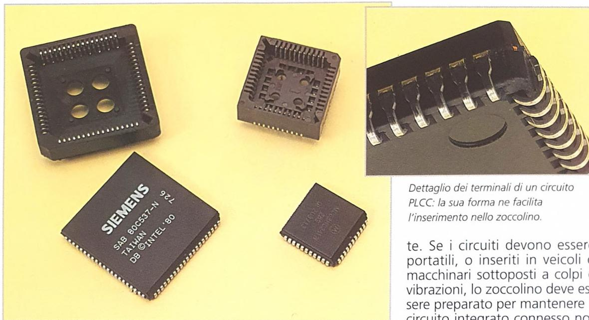
Dettaglio dei terminali di un circuito PLCC: la sua forma ne facilita l'inserimento nello zoccolino.
