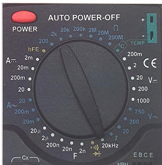
Selettore di scala e misura di un multimetro digitale.
