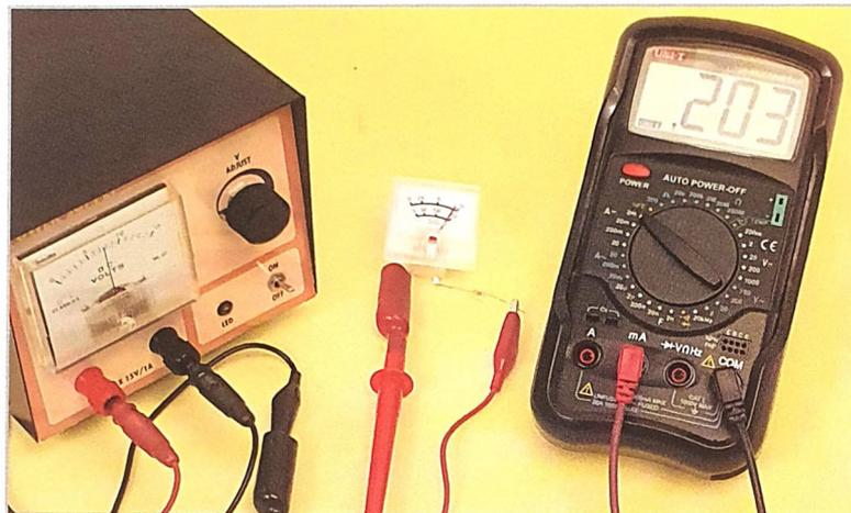
Prova effettiva di verifica dello strumento del laboratorio: dato che i due strumenti sono collegati in serie, devono dare tutti e due la medesima lettura, a parte un piccolissimo margine di errore.
