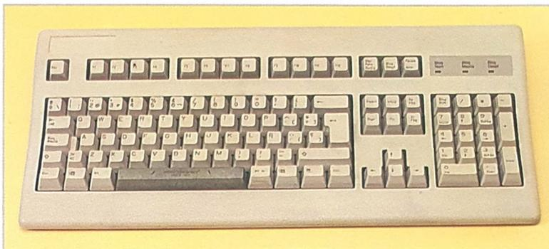
*Tastiera di computer: oltre alle zone di contatto dei tasti, è dotata di elementi di elettronica di controllo per l'invio delle informazioni al computer tramite un ridottissimo numero di fili.*
