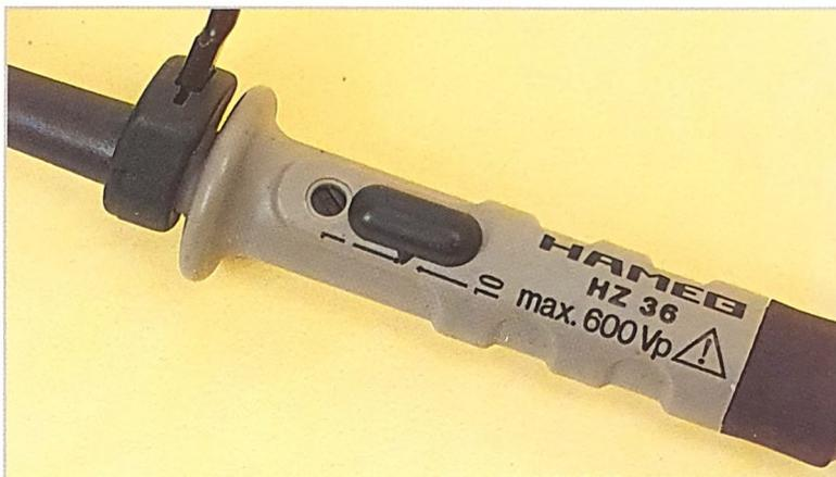
Prima di iniziare a misurare, si deve verificare la posizione del comando dell'attenuatore della sonda.
