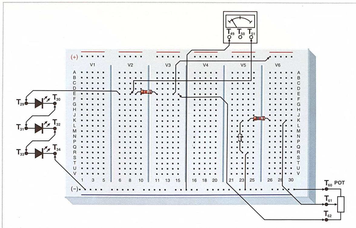
In questo esperimento si cerca di mostrare, sfruttando il voltmetro analogico, come funzionino sia i diodi LED che i diodi zener. In tutti e due i casi, per capirli, ne studieremo la risposta a una variazione della tensione d'ingresso del circuito. Così potremo vedere quale comportamento avranno.
