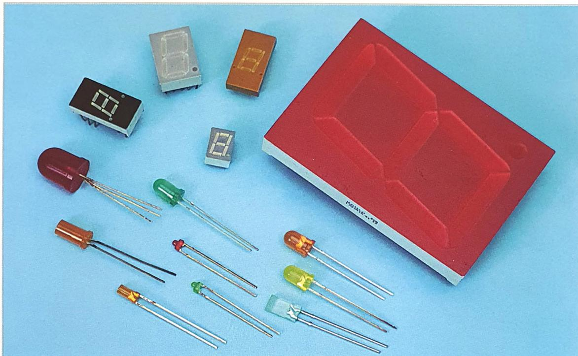
I diodi LED sono composti da un semiconduttore, generalmente arseniuro di Gallio (AsGa). La luce è emessa quando il diodo viene eccitato da un passaggio di corrente emettendo un certo numero di fotoni che è proporzionale all'intensità applicata (normalmente tra 1 e 10 mA).
