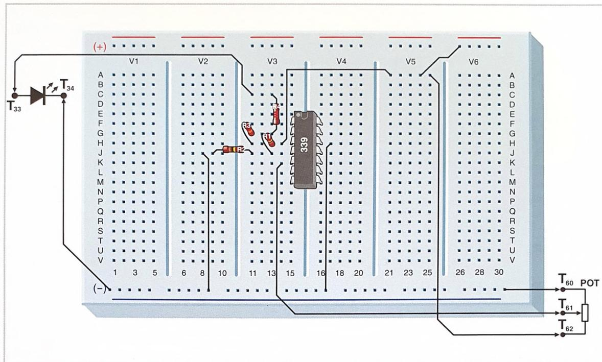
Questo circuito integrato possiede al suo interno quattro comparatori di tensione molto precisi e indipendenti tra loro. Sono stati progettati in particolar modo per lavorare con una tensione d'alimentazione con valori digitali.
