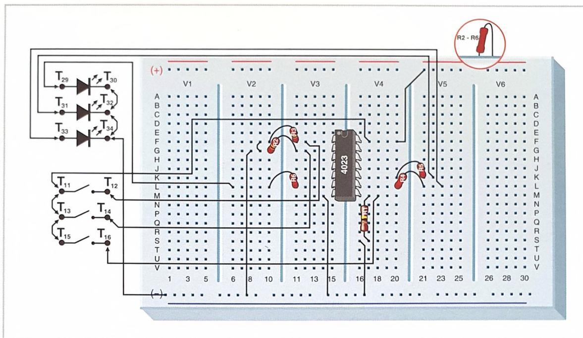
Questo circuito integrato è molto utile, perché, permettendoci di disporre delle porte NAND a tre entrate, riduce il numero dei circuiti integrati. Per formare una porta NAND a tre entrate, abbiamo bisogno di tre porte NAND a due entrate (vedi 'DIGITALE 6'). Per disporre delle tre porte NAND a tre entrate, che questo integrato contiene, sarebbe necessario utilizzare delle nuove porte NAND a due entrate, cioè tre circuiti integrati 4011.
