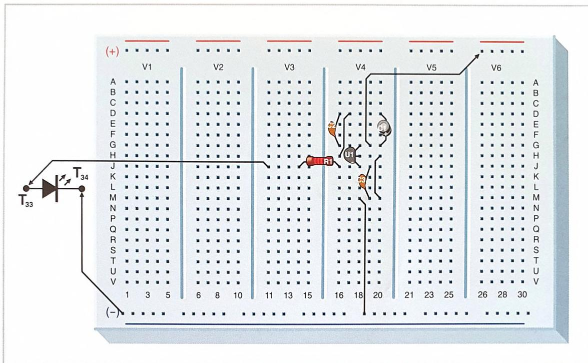
Questo circuito ammette alla propria entrata tensioni continue fino a 30V al massimo, l'uscita è stata prefissata a 5V e la massima corrente che può sopportare è di 100 mA. Dissipa una potenza massima di 500 mW, ma non dobbiamo dimenticarci di moltiplicare sempre la differenza di tensione tra l'entrata e l'uscita per la corrente che lo attraversa, per calcolare se la potenza che deve dissipare supera o meno i 500 mW.
