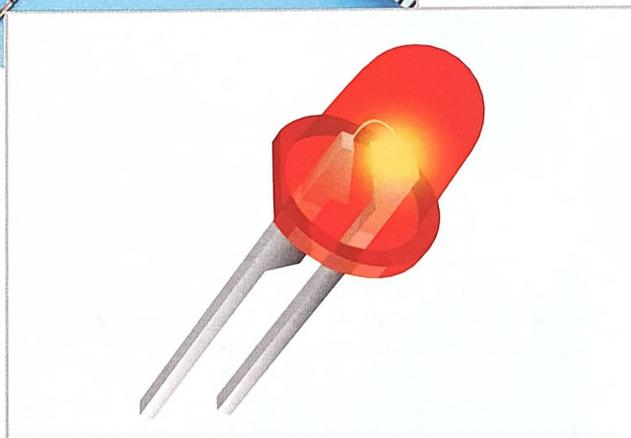
Nei diodi LED con capsula trasparente si possono facilmente distinguere anodo e catodo.
