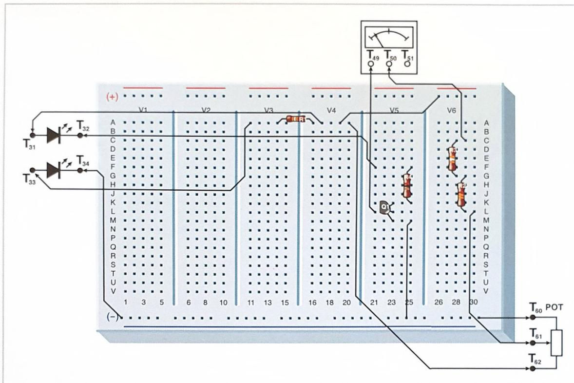
In molti esperimenti abbiamo utilizzato il transistor come commutatore oppure come amplificatore. Combinando il transistor con le porte logiche abbiamo potuto chiaramente vedere la commutazione. L'amplificazione, invece, non è così semplice da capire. Cercheremo di farlo impiegando un amperometro.
