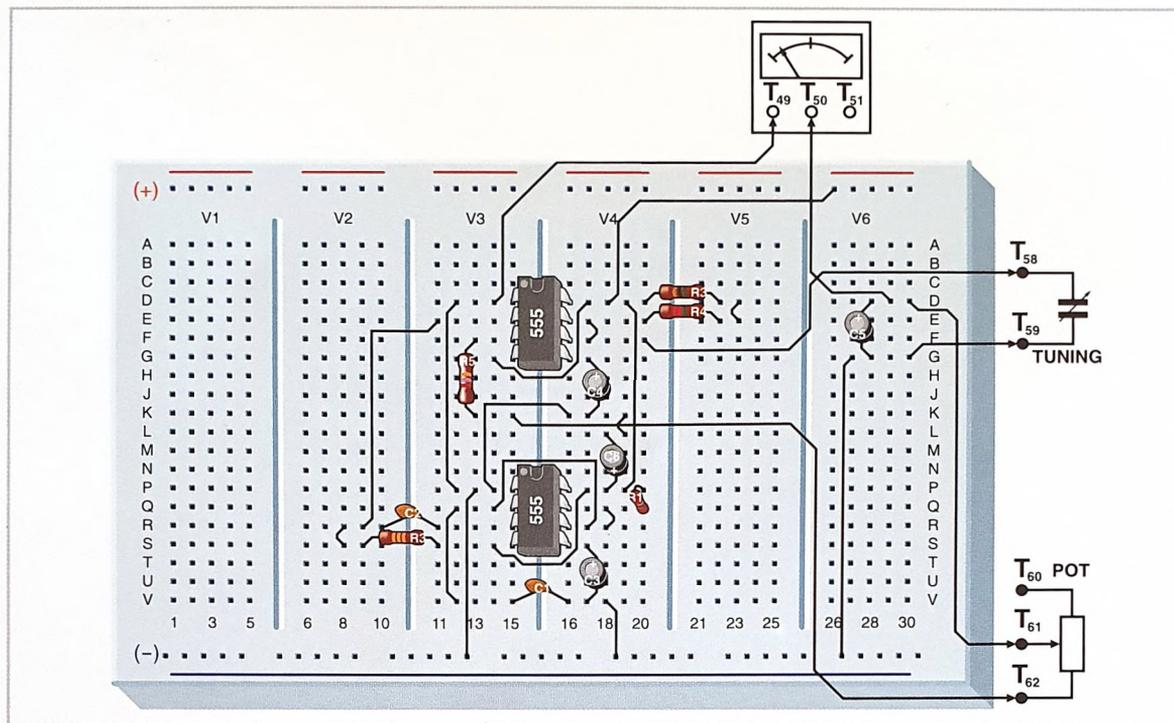
In questo esperimento si adatta il capacimetro "MISURE 22" per misurare le capacità dei condensatori di valore molto basso, fino al massimo di 500 pF. Il valore della capacità si ottiene moltiplicando la lettura della scala da '0' a '10' dello strumento di misura per 50.
