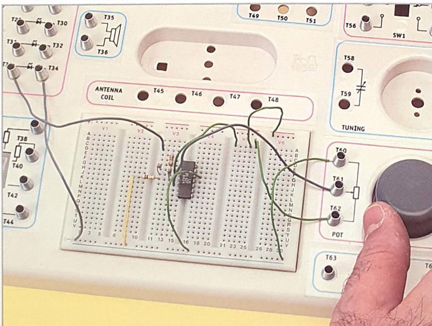
Quando in T61 si supera la tensione del terminale invertente dell'entrata il LED si illumina.
