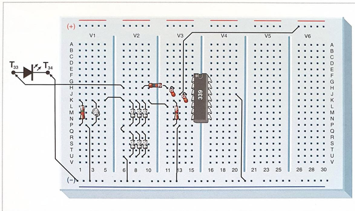
In questo esperimento si mostra come costruire una cella solare in miniatura con 6 diodi del tipo 1N4148. Il circuito si attiva quando riceve della luce e, quindi, può essere utilizzato come un circuito sensore della luce. Questo esperimento è possibile perché la capsula del diodo 1N4148 è trasparente e anche perché una giunzione fra semiconduttori genera dell'energia solare fotovoltaica.
