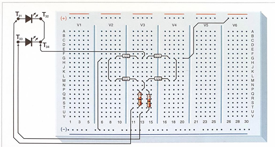
Il circuito mostra il funzionamento di un ponte rettificatore a quattro diodi. L'esperimento utilizza quattro diodi indipendenti, però il ponte rettificatore a quattro diodi è un componente a quattro terminali con diodi collegati separatamente.
