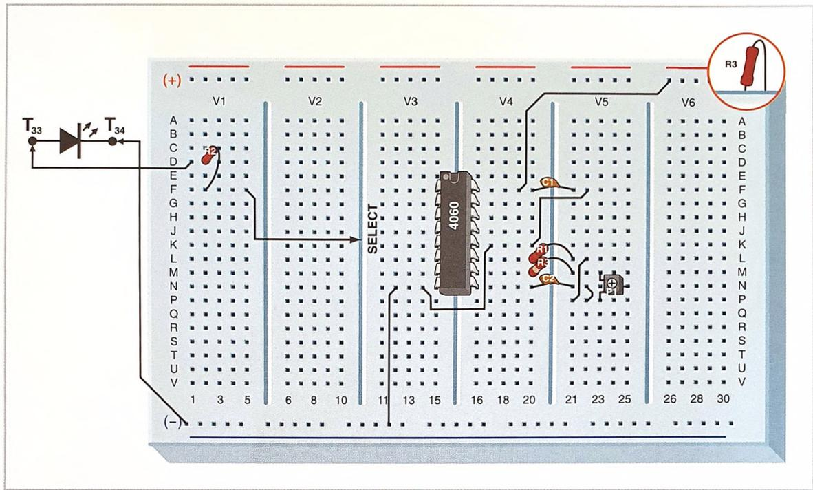
Questo circuito integrato – potremo verificarlo – dispone di numerose uscite divisorie che possono dividere il segnale del clock per 16, 32, 64 fino a 16.384. Ha un oscillatore interno che funziona aggiungendo tre componenti esterni.
