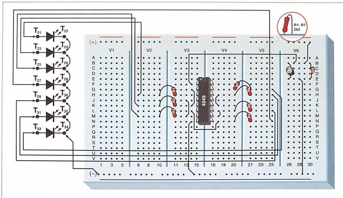
**P**rima di iniziare a utilizzare un circuito digitale in un esperimento, è consigliabile verificarne il suo corretto funzionamento, così da non avere sorprese sgradevoli, soprattutto quando si tratta di porte logiche. Le porte di questo circuito integrato sono facili da verificare perché invertono il segnale applicato alla loro entrata; possono, inoltre, fornire una corrente di uscita abbastanza elevata, del tipo buffer.
