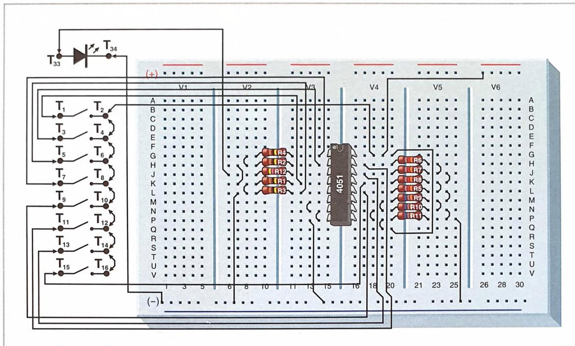
Il circuito ha al suo interno otto commutatori elettronici e un circuito speciale, chiamato multiplexer, che consente di selezionare digitalmente quale di loro si vuole attivare.
