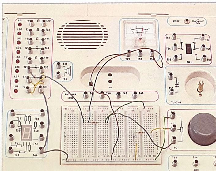
La caduta della tensione in un LED polarizzato direttamente   superiore a 1 Volt. Lo strumento di misura si utilizza come voltmetro con 10 Volt di fondoscala.
