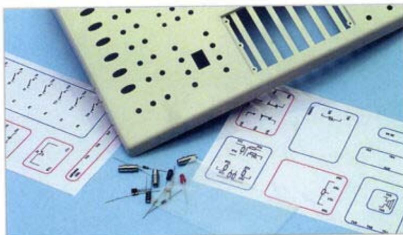
**1** Il laboratorio si monta su un supporto di plastica modellato e appositamente progettato per ospitare tutti i suoi futuri elementi. In questa prima fase si installano gli adesivi del pannello e le tre molle dei contatti ausiliari.
