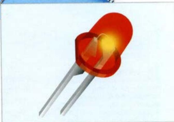
la o con un alimentatore. Bisogna interporre sempre una resistenza: possiamo provare intercalando a uno dei loro due terminali una resistenza da 3K3  $\Omega$ , sempre che la tensione continua applicata sia minore di 20 V.
