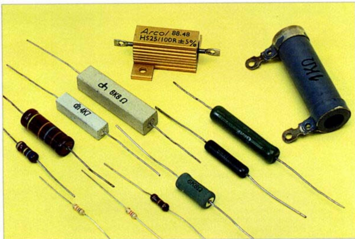
Le resistenze che si usano comunemente sono costituite da un cilindro di materiale isolante ricoperto da un altro materiale – avente una determinata resistività e di spessore sottile, calibrato per garantire alla resistenza un valore più preciso possibile. Alle due estremità ha un contatto metallico a boccia inserito a pressione al quale vanno uniti i terminali; tutto l'insieme risultante è di nuovo ricoperto da materiale isolante.
