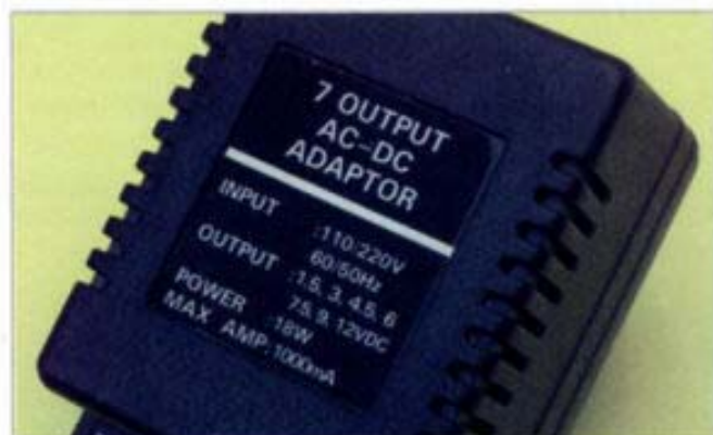
Piastra di identificazione che indica AC per l'entrata e DC per l'uscita.
